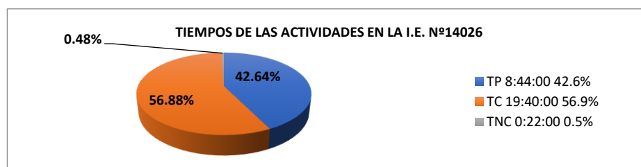
Figura 3: Carta balance – Partida Encofrado y desencofrado en columnas
