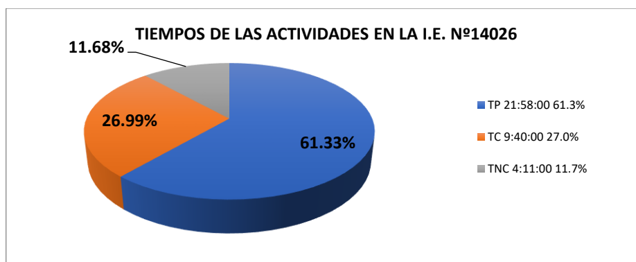
Figura 15: Carta balance – Partida de concreto f'c=210 kg/cm 2 en columnas
