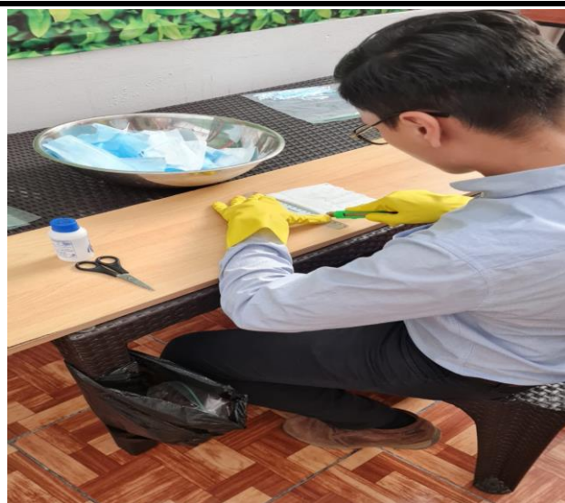
Fotografía N°11: Proceso de elaboración de fibras de mascarillas.
