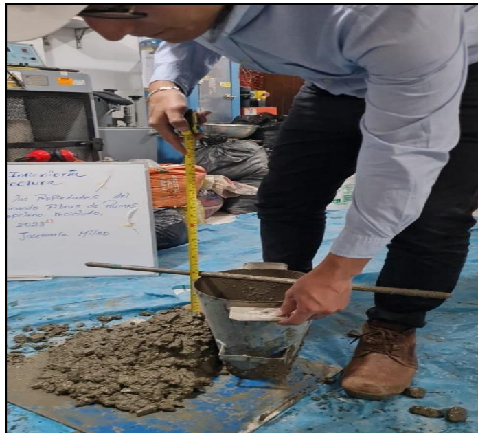
Figura 62. Medición de asentamiento del concreto
