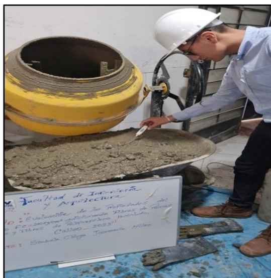
Figura 64. Medición de temperatura del concreto
