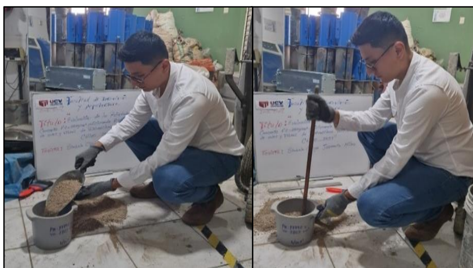
Figura 49. Determinación del peso unitario suelto y compactado del AF
