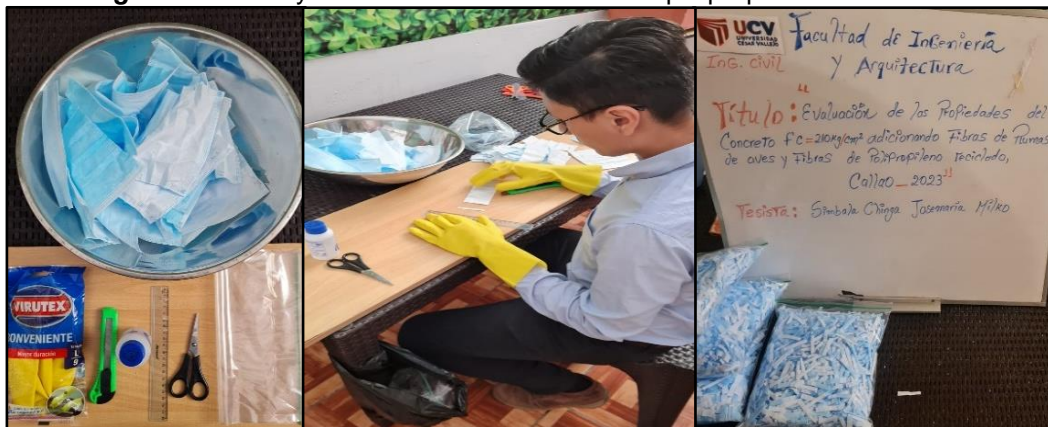
Figura 44. Corte y almacenamiento de fibras de polipropileno reciclado
