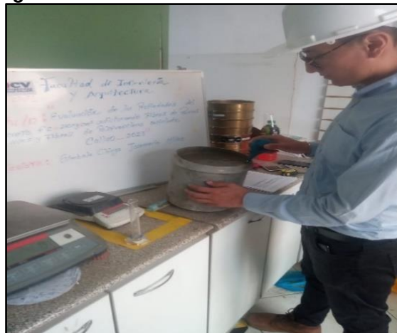
Figura 70. Medición de la exudación del concreto
