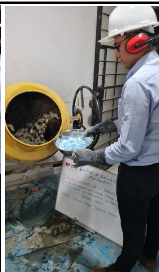
Fotografía N°17: Proceso de mezclado adicionando ambas fibras al concreto.
