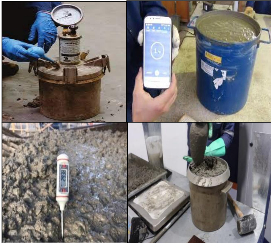
Figura 20. Ensayos en concreto fresco
