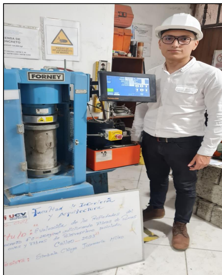
Figura 71. Determinación de la resistencia a la compresión del concreto
