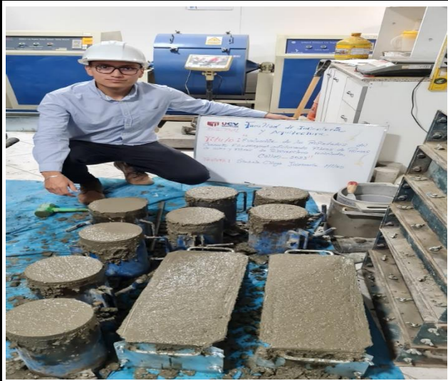
Fotografía N°20: Preparación de probetas cilíndricas y vigas prismáticas.
