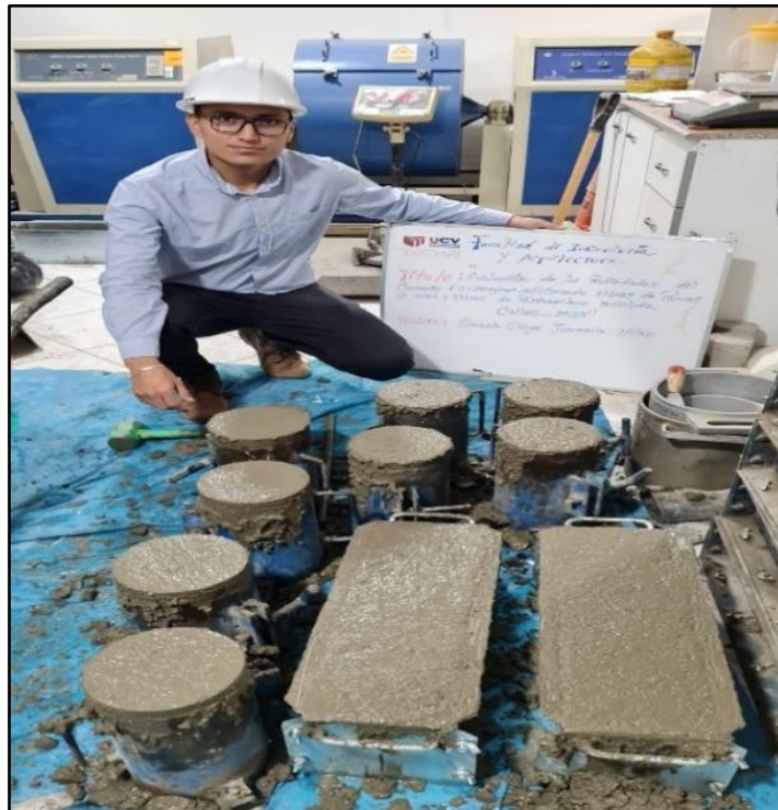
Figura 61. Llenado de probetas y vigas prismáticas
