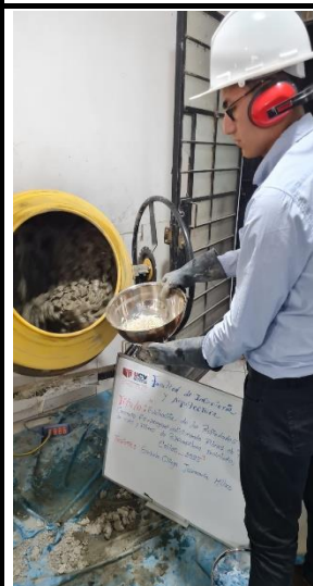
Fotografía N°17: Proceso de mezclado adicionando ambas fibras al concreto.
