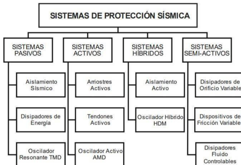
Figura 3. Cuadro de sistemas de protección sísmica.
