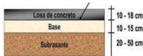
Figura 12. Diseño de los espesores de las capas de pavimento. Fuente: Elaboración propia
