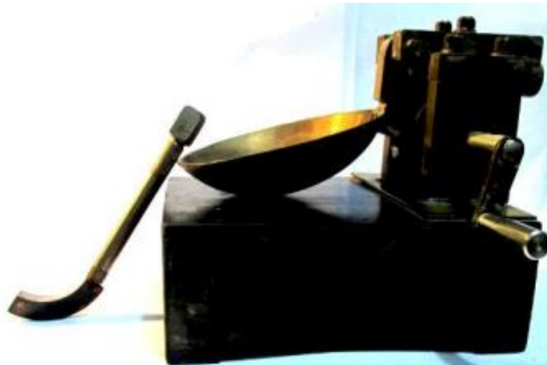
Figura 3. Copa de casagrande y ranurador del tipo ASTM. Fuente: Fundamentos de ingeniería geotécnica suelos y cimentaciones, p. 27.
