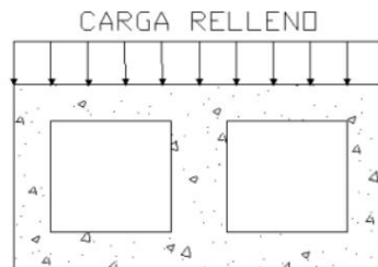
Figura 12: empuje lateral sobre la alcantarilla.
