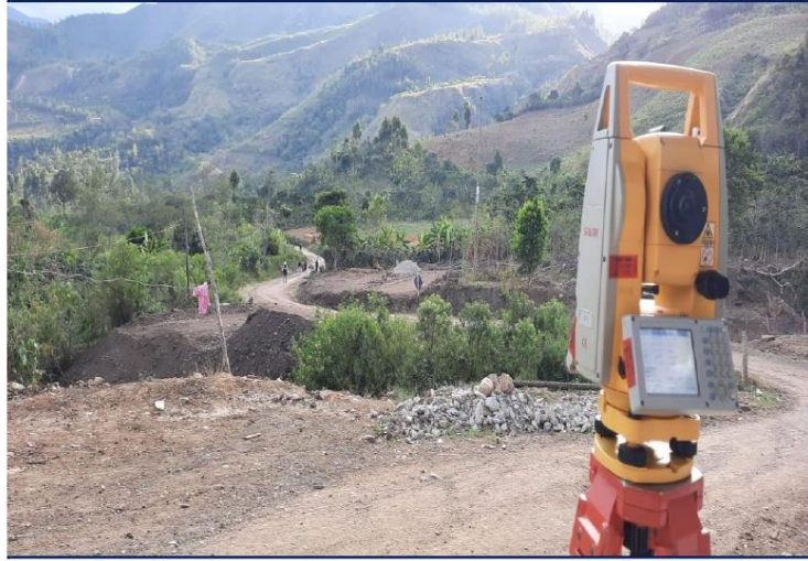
IMAGEN N° 03. REALIZACIÓN DEL LEVANTAMIENTO TOPOGRÁFICO CON ESTACIÓN TOTAL.
