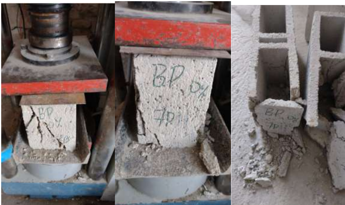
Rotura de bloques para resistencia a la compresión por unidad a los 7, 14 y 28 días para sustituciones al 10%, 12% y 16%
