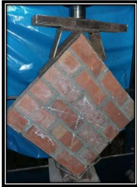
Figura 11. Ensayo a compresión diagonal de muretes Fuente: (Zuniga Quispe, y otros, 2017)
