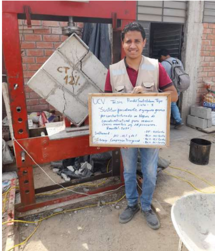
Falla por tensión diagonal parte baja y deslizamiento parte superior derecha Fuente: Elaboración propia.
