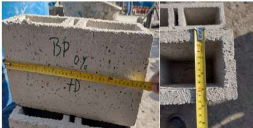
Figura 14. Medición de bloques de concreto Fuente: Elaboración propia
