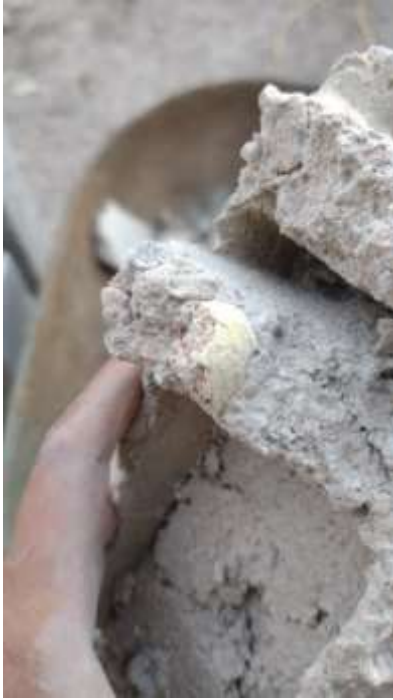
Evidencia de corcho triturado embebido en estado endurecido de bloque de concreto Fuente: Elaboración propia.
