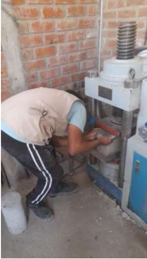
Realizando ensayo de rotura resistencia a la compresion axial unidad Fuente: Elaboración propia.
