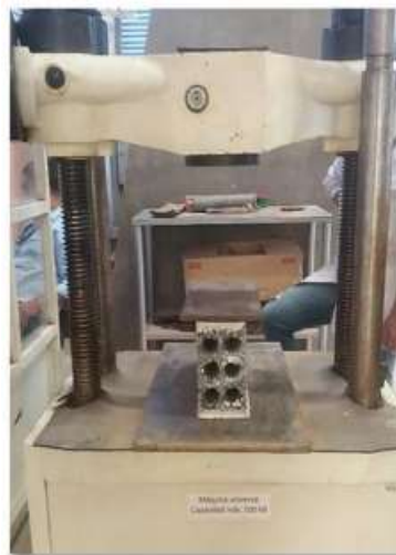
Figura 10. Ensayo de resistencia a la compresión Fuente: (Mayorga Garcia, y otros, 2019)
