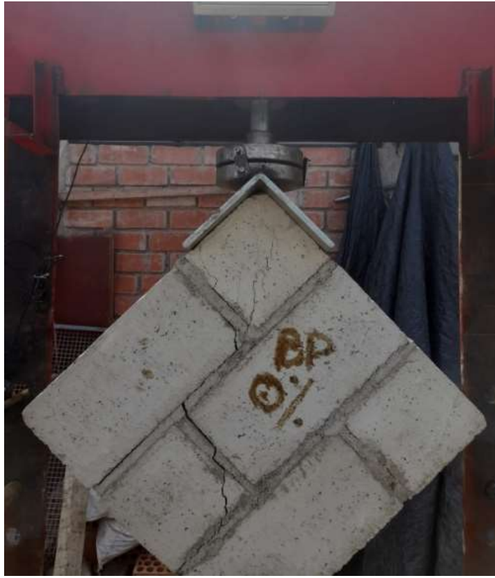
Falla por deslizamiento y por tensión diagonal en juntas Fuente: Elaboración propia.
