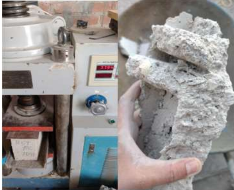
Figura 16. Ensayo de la resistencia a la compresión del bloque de concreto a los 7 días
