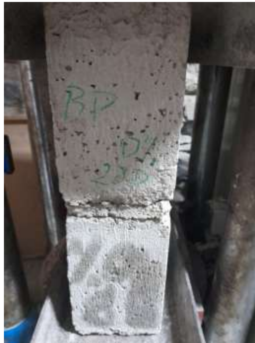
Ensayo Resistencia compresión Pilas Fuente: Elaboración propia.
