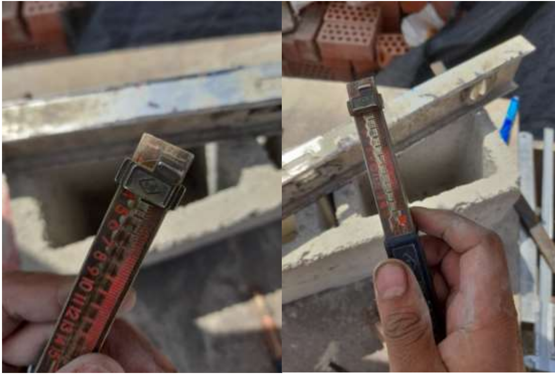
Herramienta usada para medición de ALABEO de bloques Fuente: Elaboración propia.
