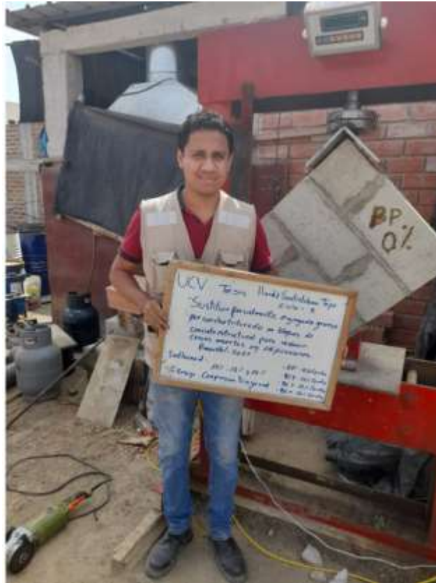
Ensayo de resistencia compresión Diagonal Fuente: Elaboración propia.
