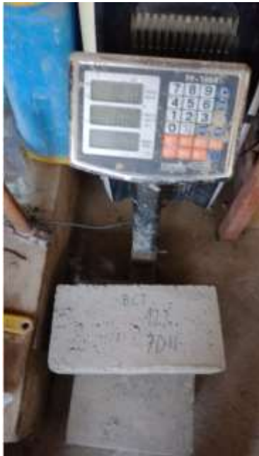
Pesado de Bloques antes de ser ensayados a compresión.
