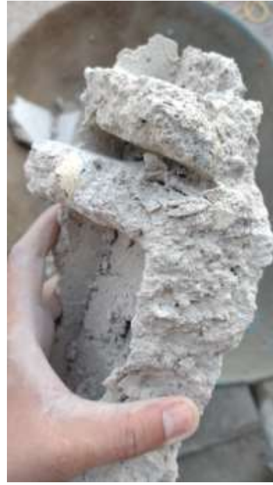
Evidencia de corcho triturado embebido en estado endurecido de bloque de concreto Fuente: Elaboración propia.
