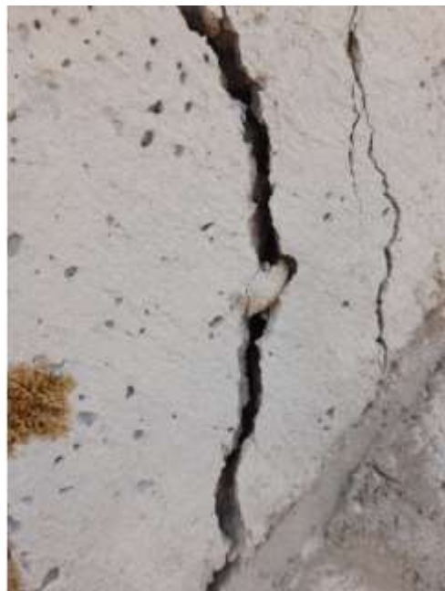
Exposición de Corcho triturado en falla por tensión diagonal
