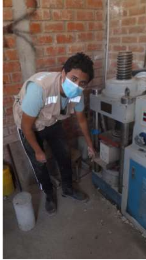
Realizando ensayo de rotura resistencia a la compresion axial unidad Fuente: Elaboración propia.
