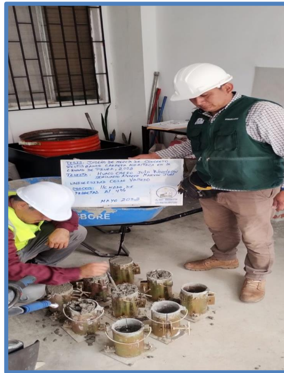
Llenado de probetas con el 4% de agregados de material regenerado.
