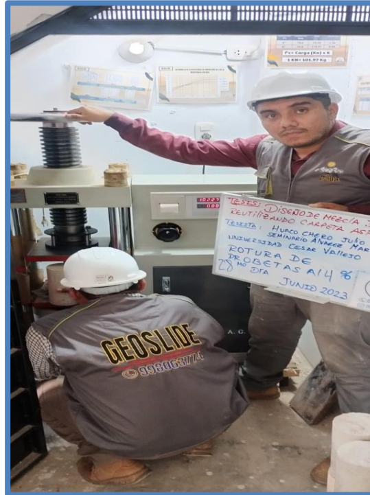
Ingreso de testigos al 28avo día, después del llenado de probetas.
