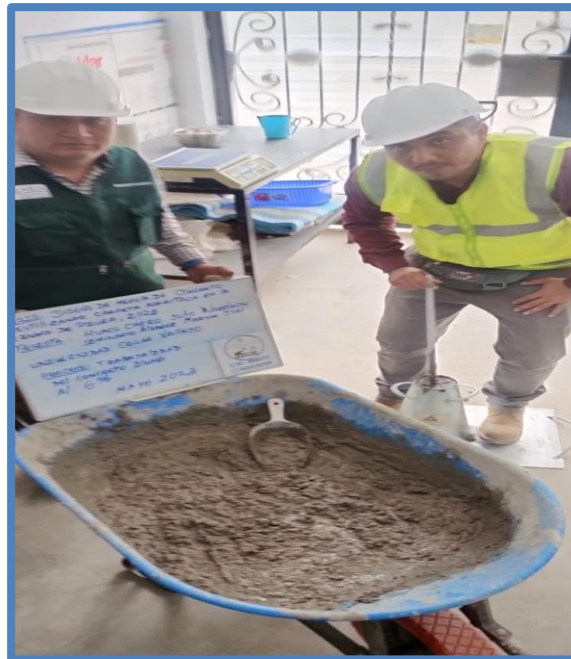
Verificación de la trabajabilidad del concreto con reemplazo del 2% de los agregados regenerados de la carpeta asfáltica.
