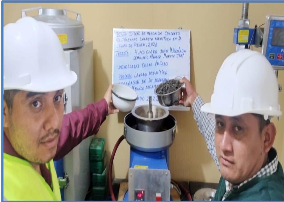
Lavado del material asfáltico regenerado para obtención de agregados.
