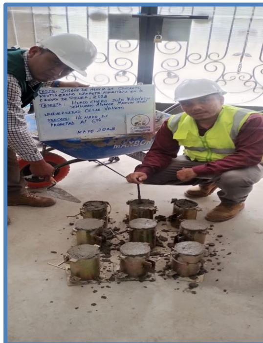
Llenado de probetas con el 6% de agregados de material regenerado.
