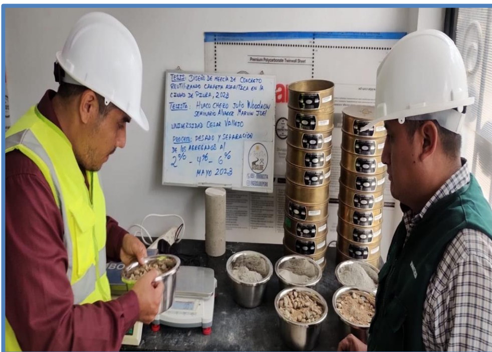
Pesado y separación de los agregados regenerados al 2%, 4% y 6%.
