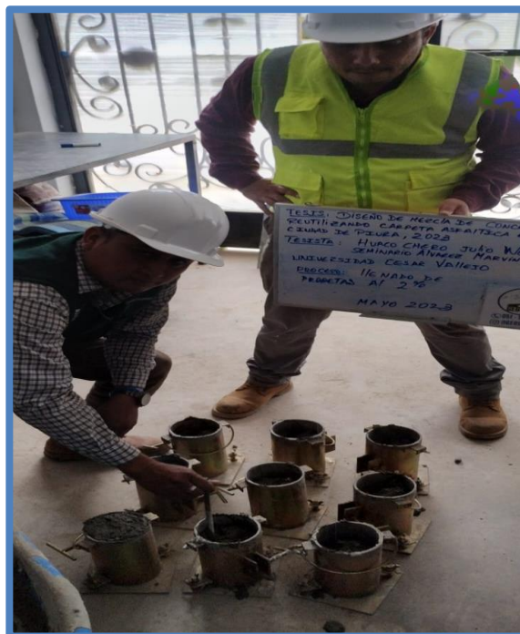
Llenado de probetas con el 2% de agregados de material regenerado.
