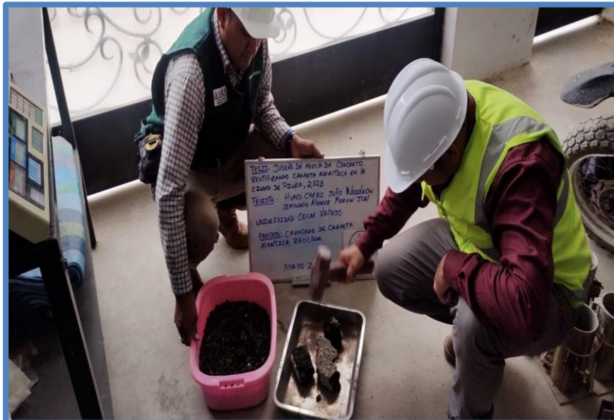
Triturado de material regenerado de carpeta asfáltica, para posteriores ensayos.
