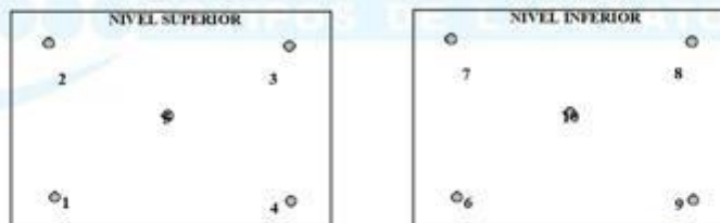
Fig. 3.- Posición de los termopares en los planos.
