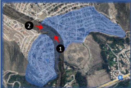
Esta quebrada esta desembocando en el rio Rímac directamente por debajo de la carretera central, no cuenta con ningún sistema de seguridad como muros de contención, dique , mallas geodinamicas carteles de seguridad.
