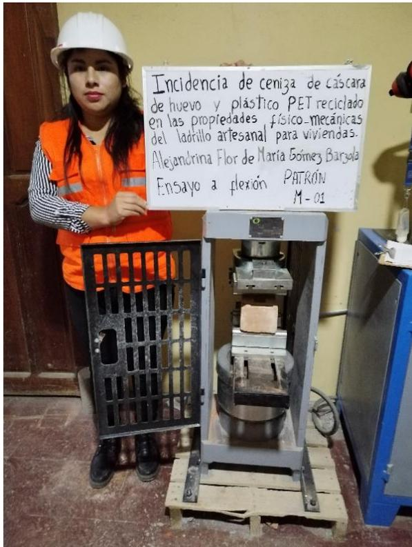
Figura 26. Resistencia a la flexión de la muestra patrón
