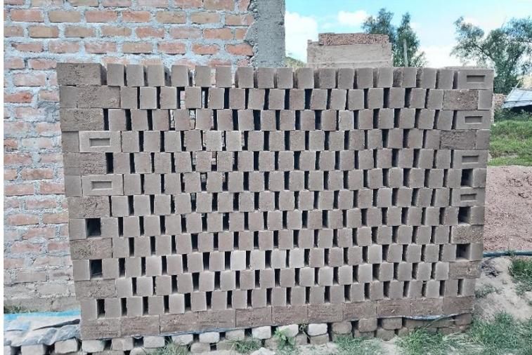
*Figura 20. Secado de los ladrillos*
