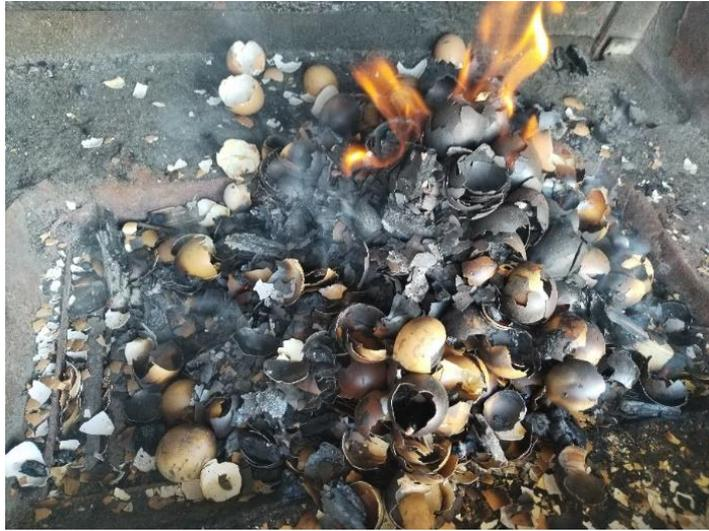
Figura 11. Proceso del quemado de la cáscara de huevo
