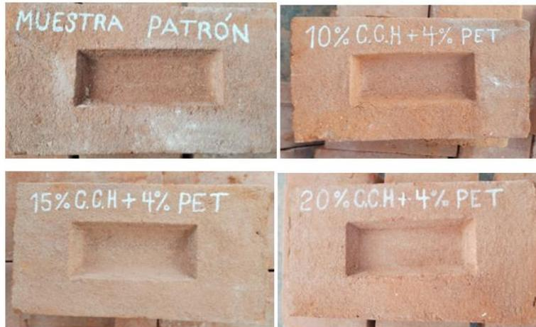
Figura 8. Ladrillos con adiciones y muestra patrón
