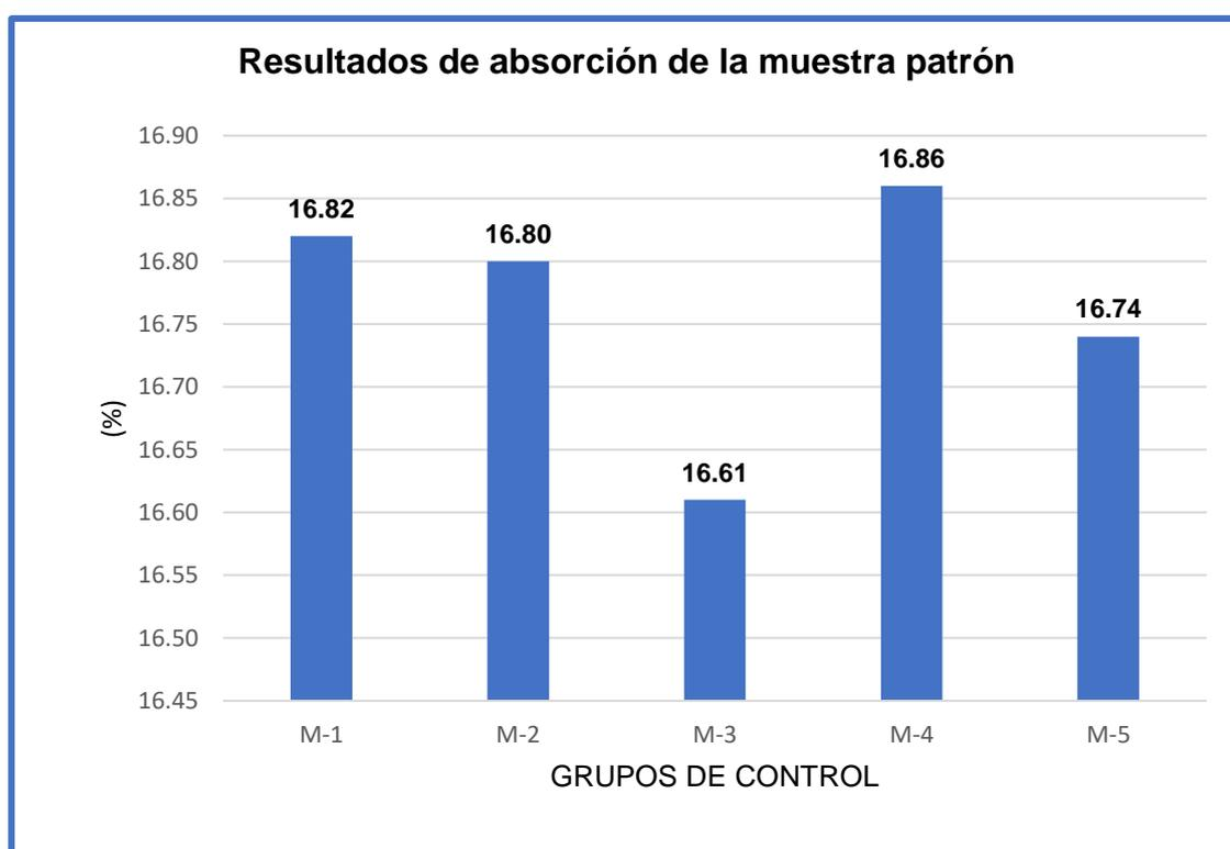
**Figura 43. Resultados de absorción de la muestra patrón**
