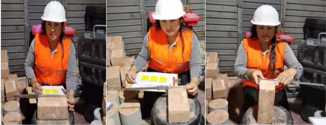
*Figura 30. Prueba de variación dimensional*
