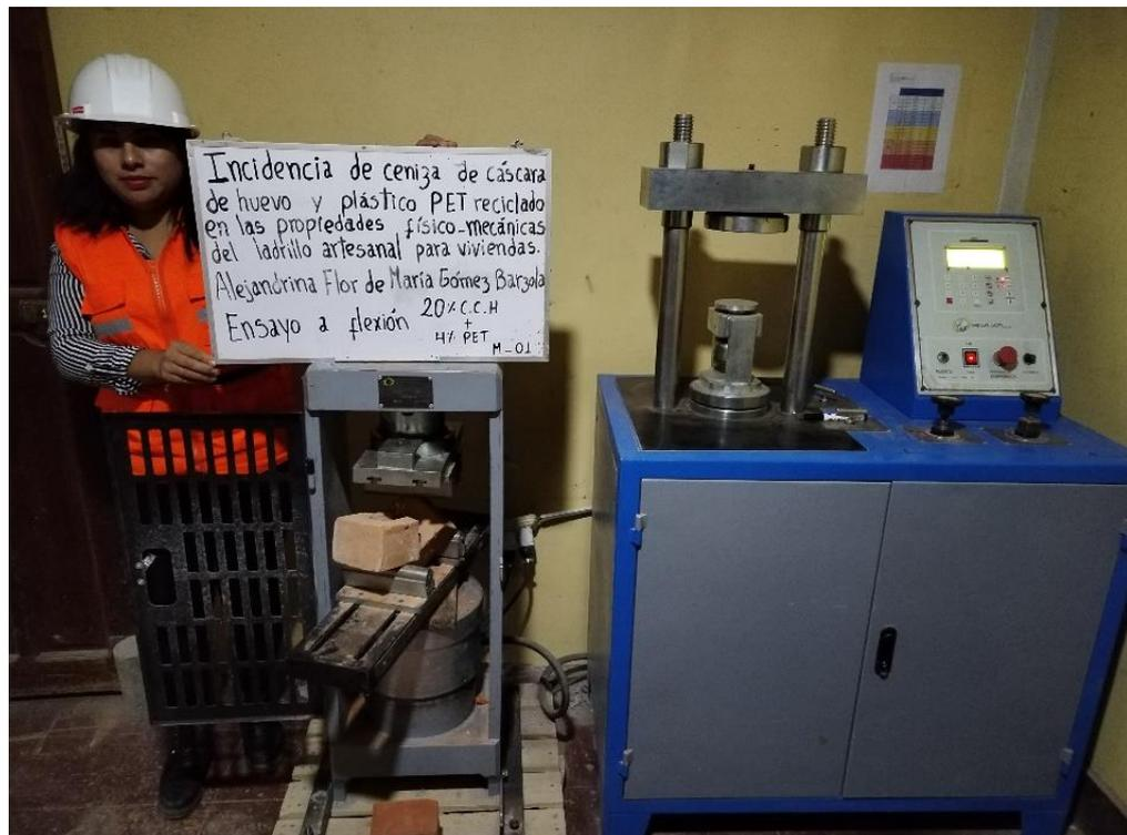
Figura 29. Resistencia a la flexión con adición de 20% C.C.H + 4% PET
