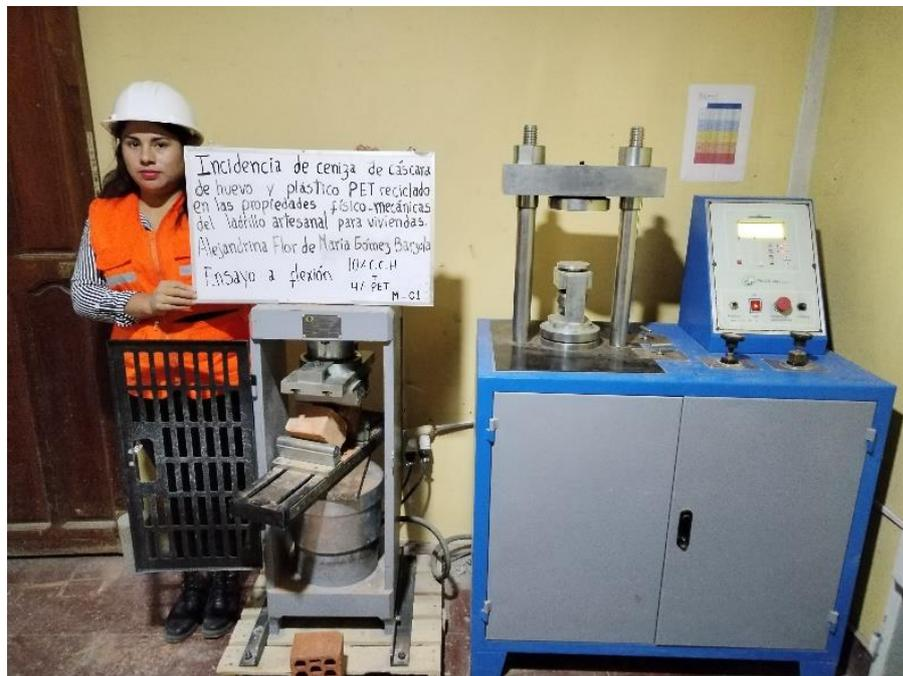
Figura 27. Resistencia a la flexión con adición de 10% C.C.H + 4% PET
