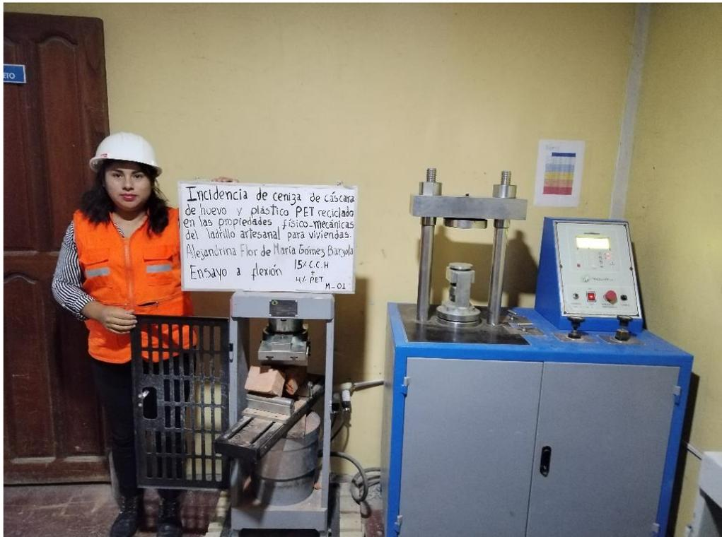
Figura 28. Resistencia a la flexión con adición de 15% C.C.H + 4% PET
