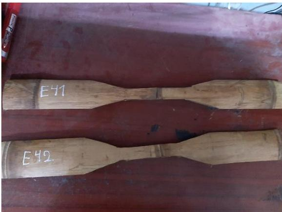
**Figura 35.** Muestra-ensayo de tracción
