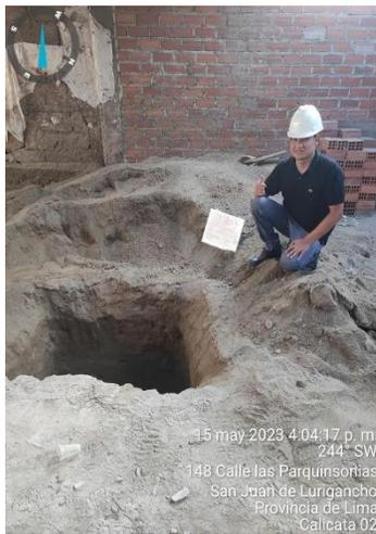
**Figura 31.** Calicata 02: 1.50x1.50 metros con profundidad 3 metros
