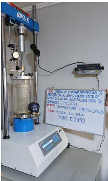
**Figura 32.** Ensayo Triaxial en el suelo
