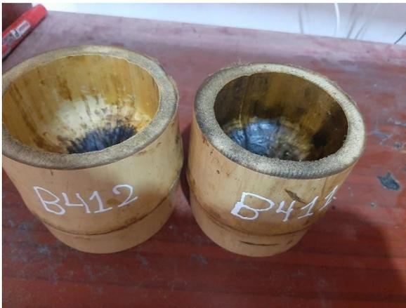
**Figura 34.** Muestra-ensayo de corte
