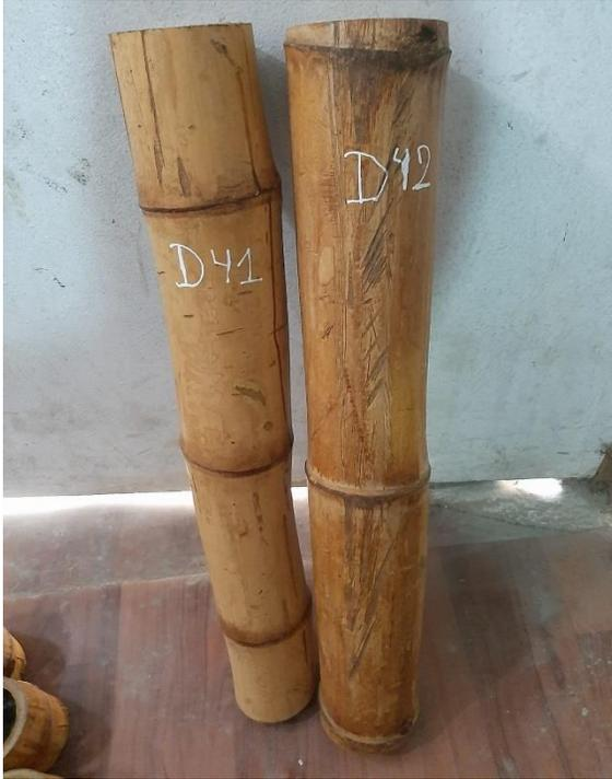
**Figura 36.** Muestra-ensayo de flexión
