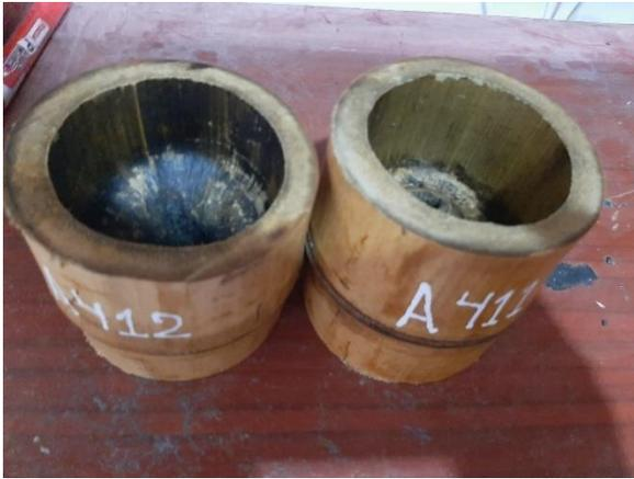
**Figura 33.** Muestra-ensayo de compresión
