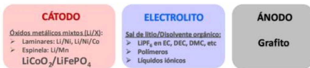
Figura 6 Principales Componentes de las Baterías de ion Litio Fuente : Catedra Endesa, Elaboracion Propia
