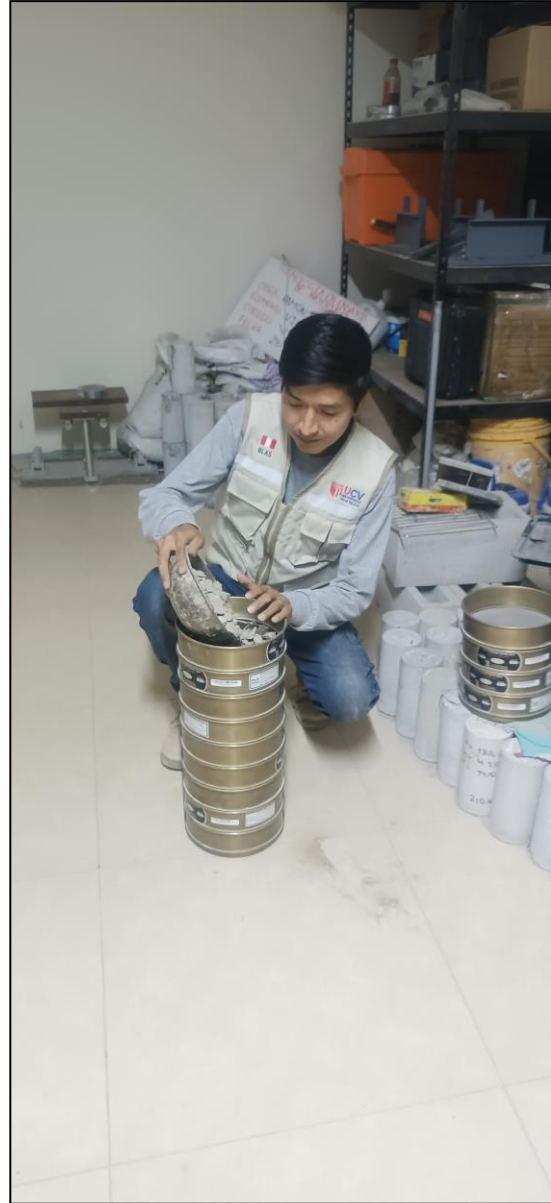
Proceso de análisis granulométrico por tamizado de los agregados.
