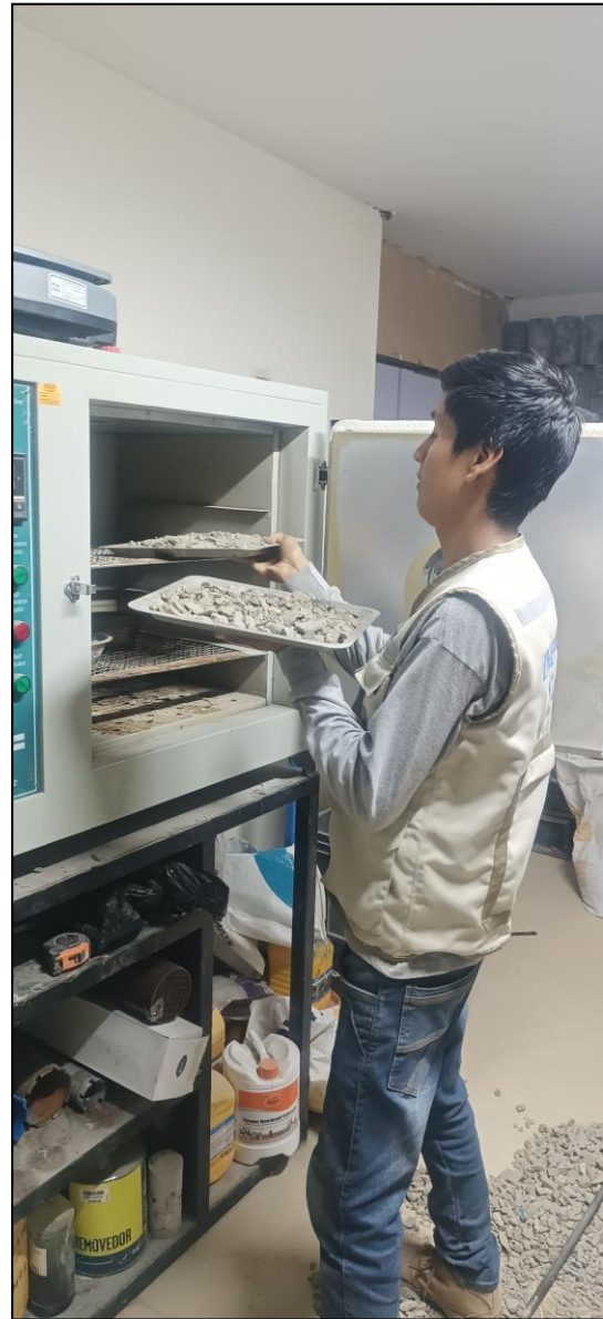
Proceso de determinación del contenido de humedad total de los agregados.
