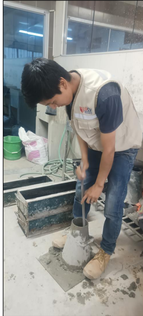
Realización del ensayo de asentamiento con ayuda del cono de Abrams.
