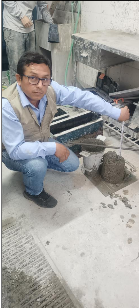
Realización del ensayo de asentamiento con ayuda del cono de Abrams.
