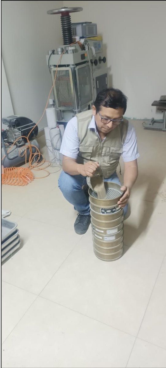
Proceso de análisis granulométrico por tamizado de los agregados.
