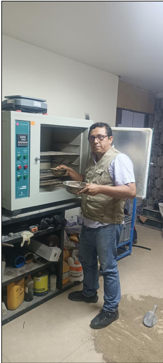
Proceso de determinación del contenido de humedad total de los agregados.
