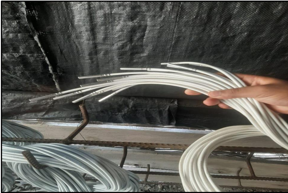
Figura 18: Cordón detonante utilizado en mina Anta Sunqu.
