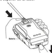
EXTRACCIÓN DE LA BATERIA
