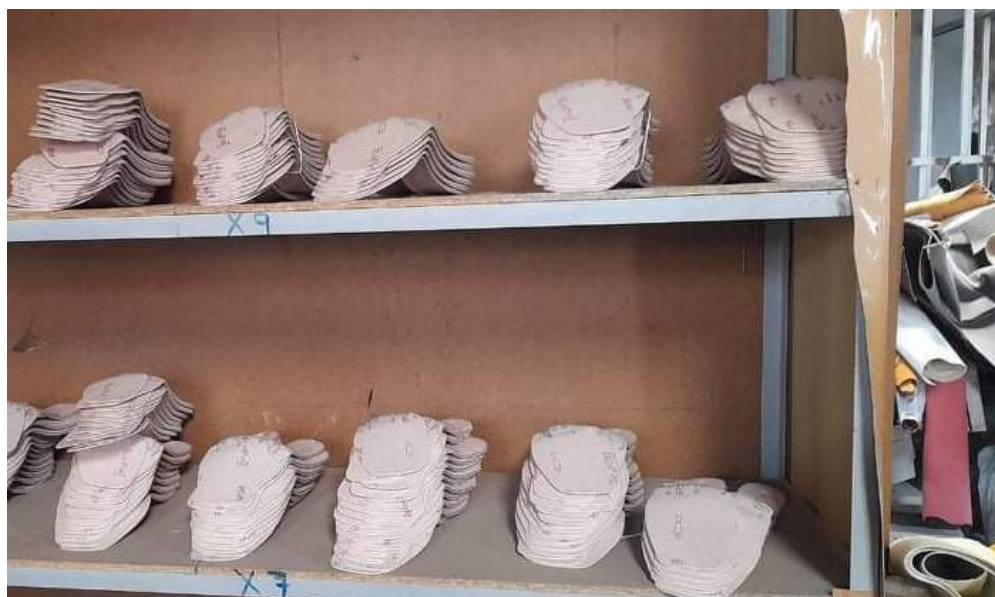
Figura 26 Moldes de cartón pre implementación poka yoke
