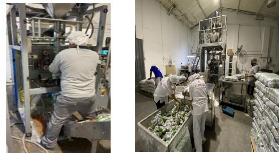
Figura 19: Área de Producción / Operario de la Máquina Envasadora Vertical Automática
