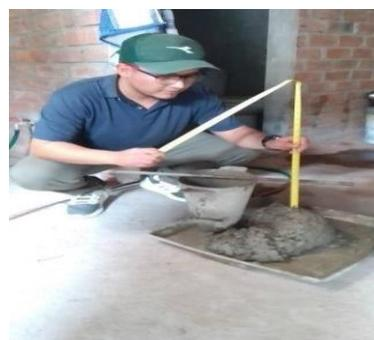
**Figura 03:** Ensayo de consistencia
