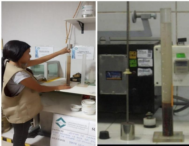
Figura 23: Ensayo equivalente de arena
