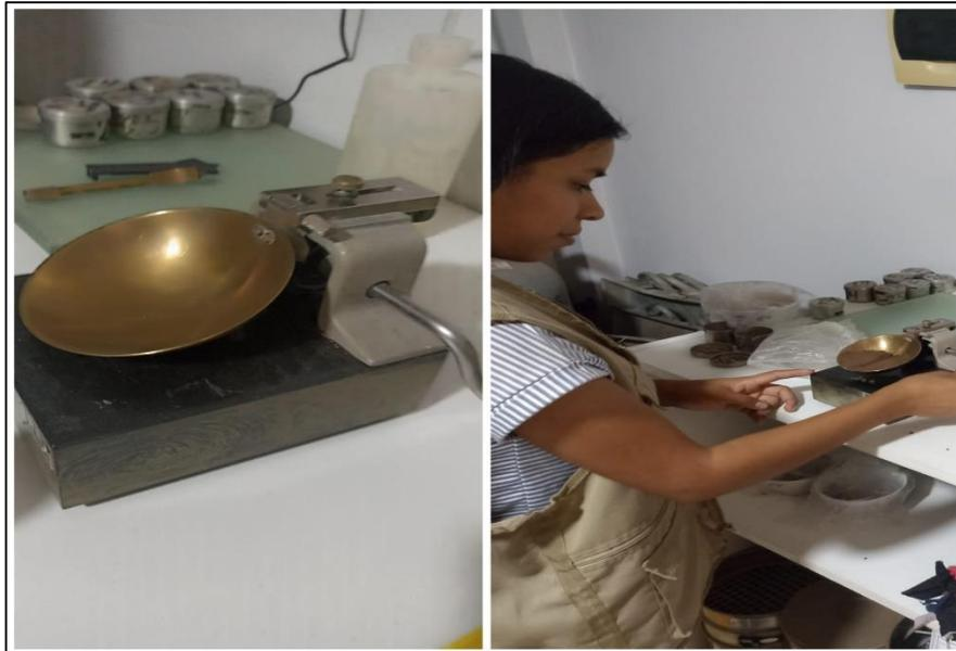
Figura 24: Cuchara Casa Grande y el ensayo de limite liquido
