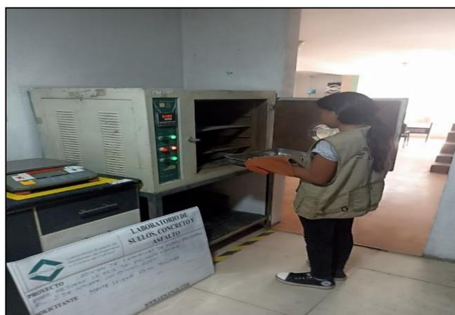
Figura 21: colocación de la muestra al horno
