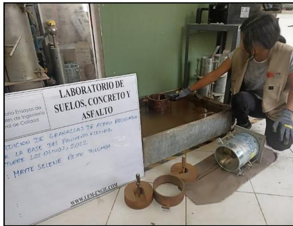
Figura 28: Muestra Sumergida Por 4 Días
