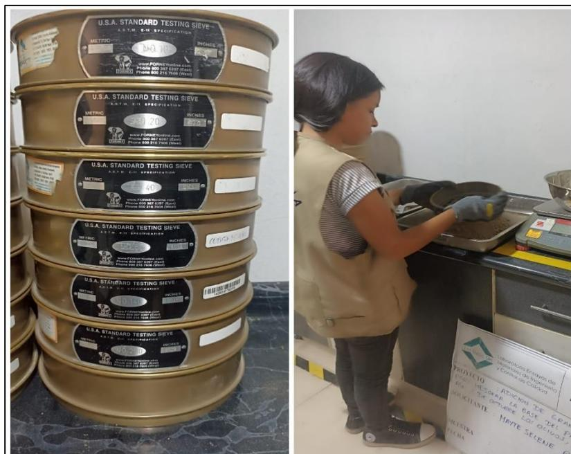
Figura 22: tamices para ensayos de granulometría
