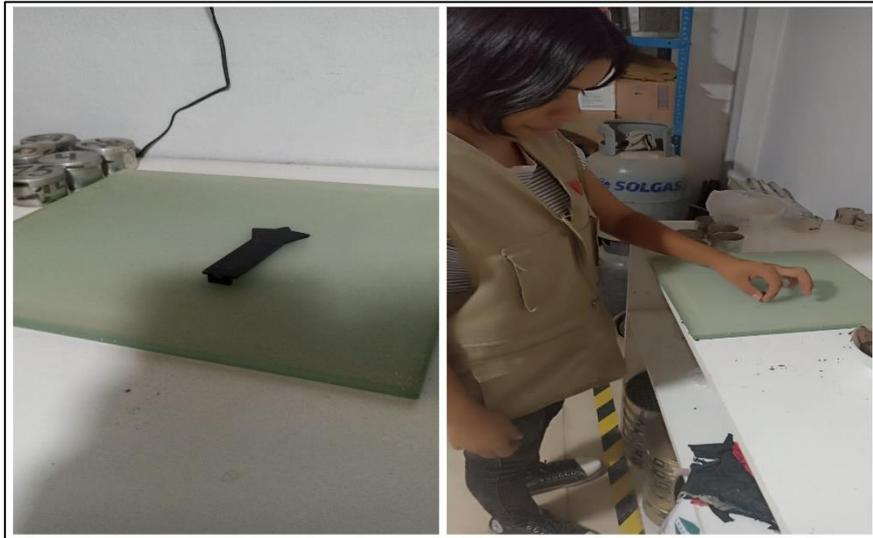
Figura 25: Vidrio esmerilado y el ensayo de limite plástico
