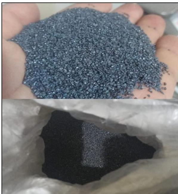
*Figura 18: Material a adicionar granallas de acero*
