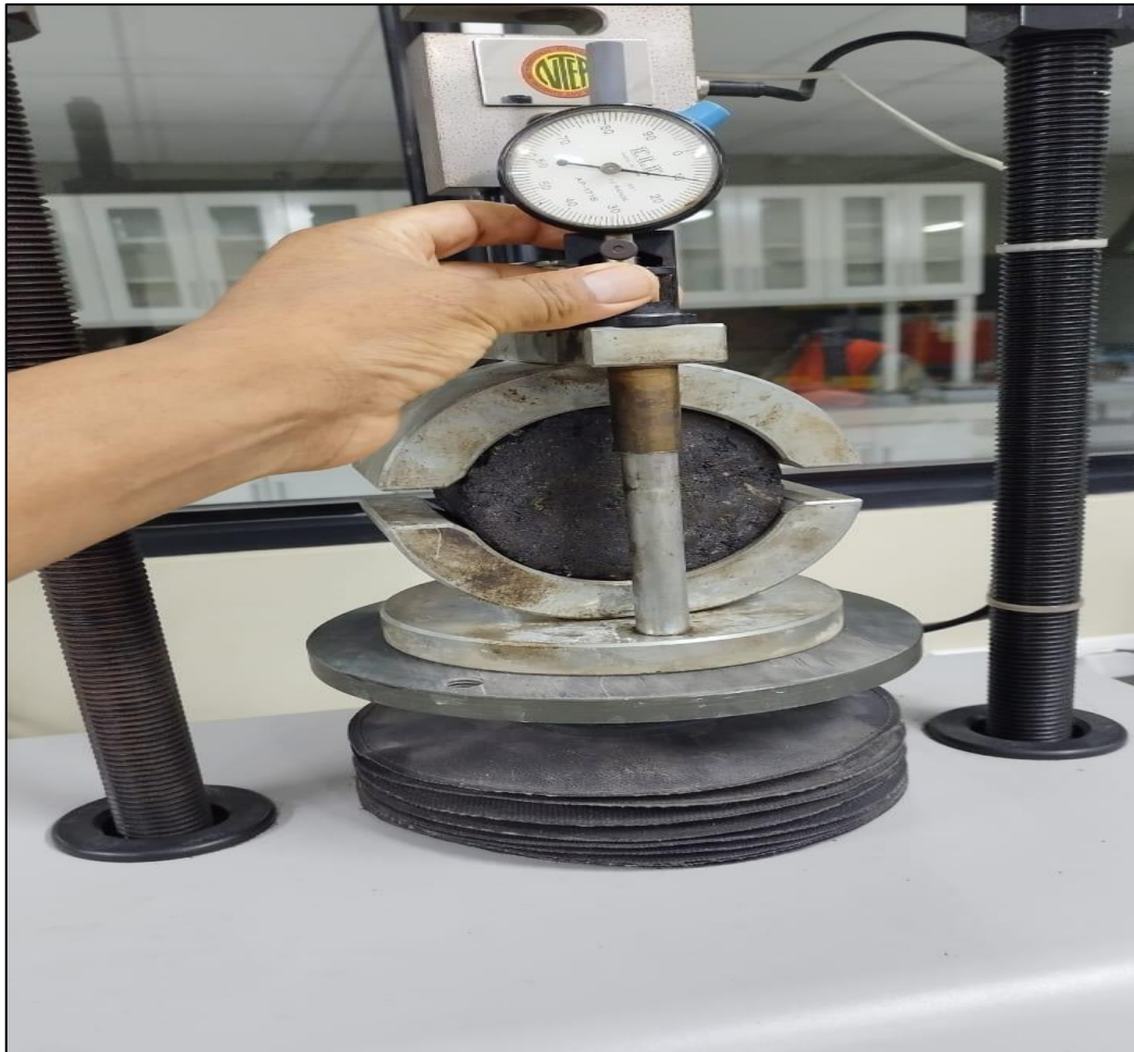
Fotografía 7. ensayo de resistencia y flujo
