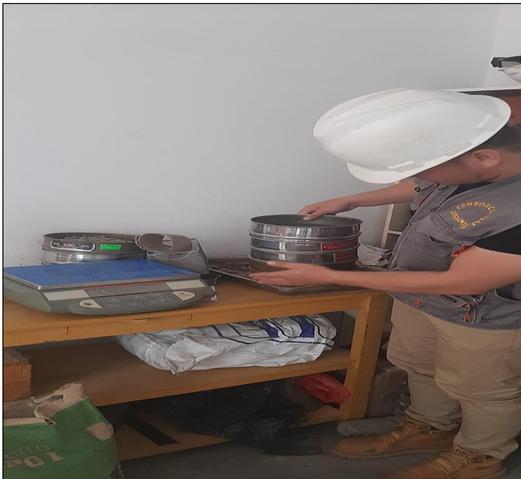
Fotografía 1. Ensayo granulométrico agregado fino
