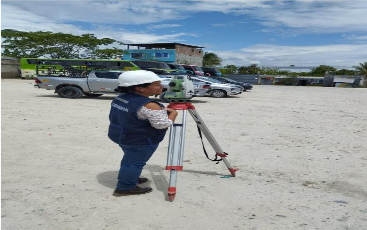
**Fotografías: 1** Tesistas con la estación total realizando el levantamiento topográfico en el terminal terrestre Bagua.
