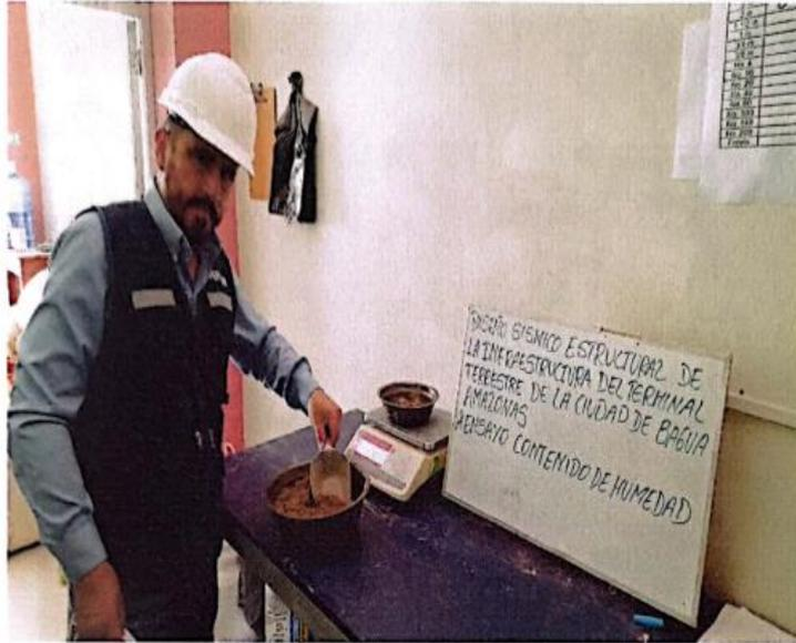
FOTOGRAFIA 03: TESISTA EN EL LABORATORIO COLOCANDO PARTE DE LA MUESTRA PARA PESARLO PARA EL ENSAYO DE HUMEDAD DE LA C-01.
