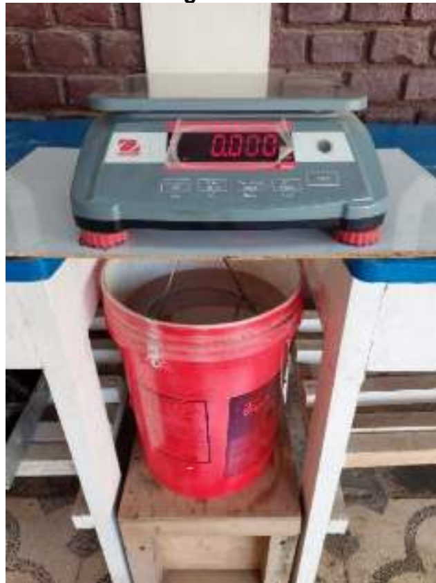
Vista de Equipo para realizar peso específico de briquetas.
