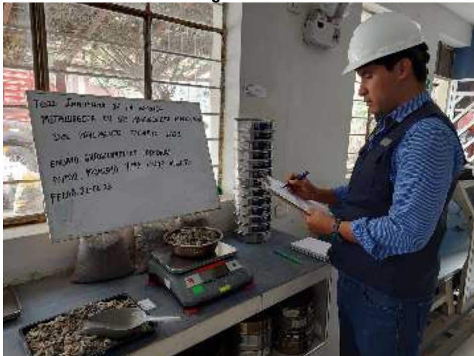
Vista de Granulometría del agregado grueso.
