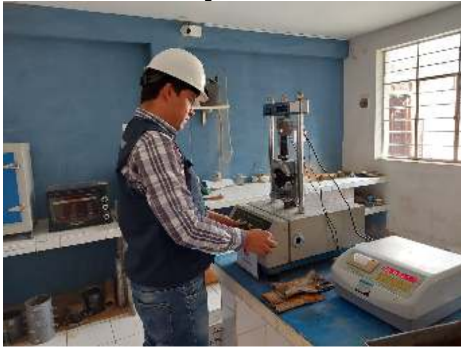
Vista de Ensayo Marshall.
