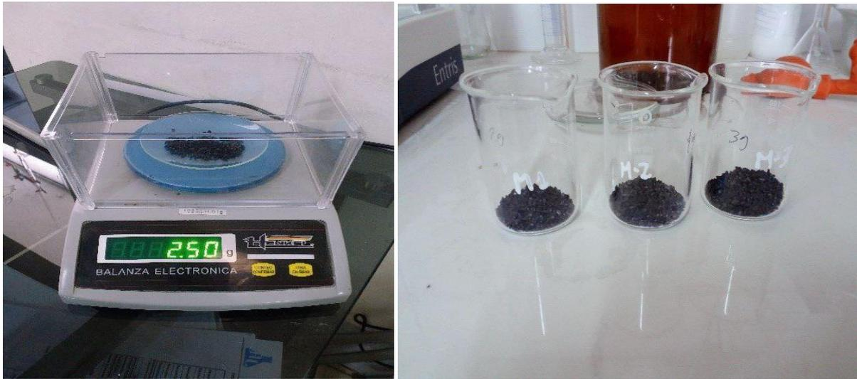
**Fotografía 04: Oxidación del cianuro, con adición de carbón vegetal y mediante agitación magnética**
