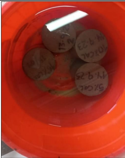
Curado en sulfatos (sulfato de magnesio)
