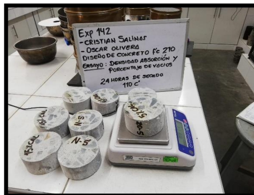
Figura 34. Pesado de moldes
