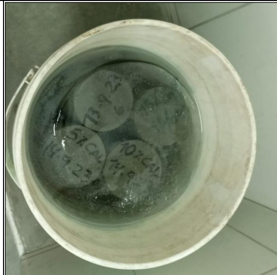
Probetas en congelación y deshielo
