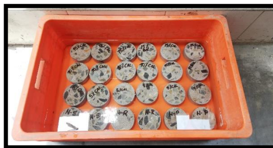
Figura 31. Saturado en agua
