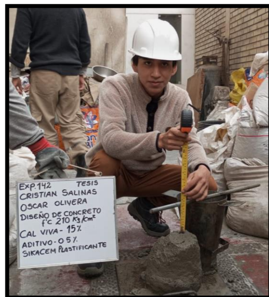
Figura 10. Medición de asentamiento
