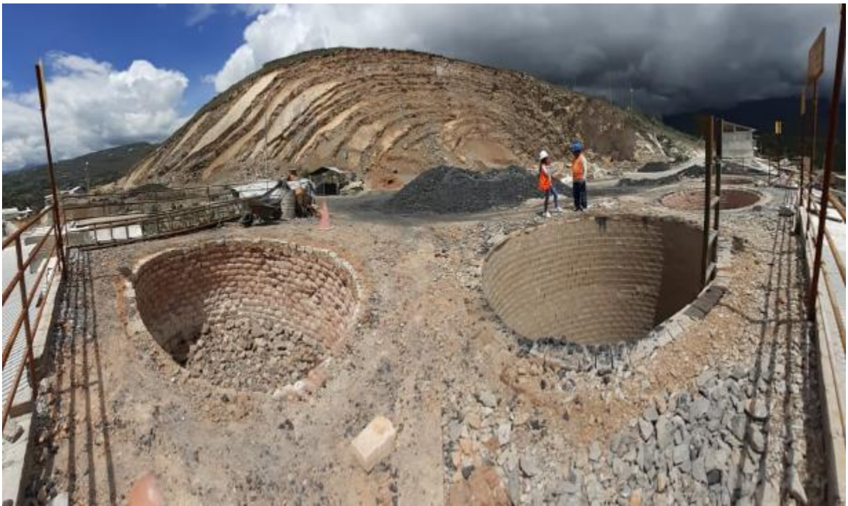
Horno de producción – quema a 1000 °C
