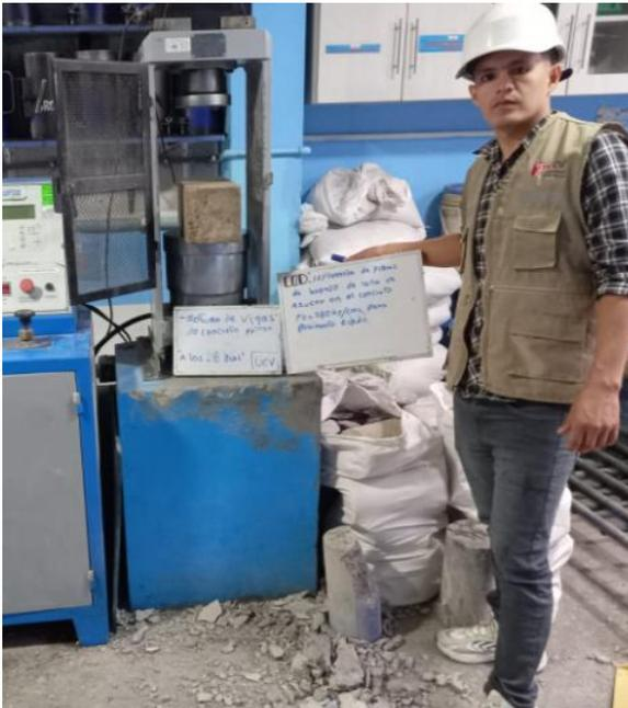
figura 27: ensayo de resistencia a la flexión a los 28 días
