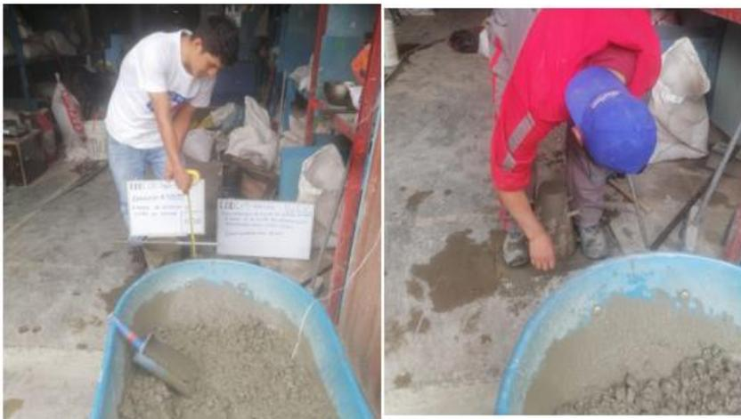
**figura 24:** ensayo de Slump del hormigón
