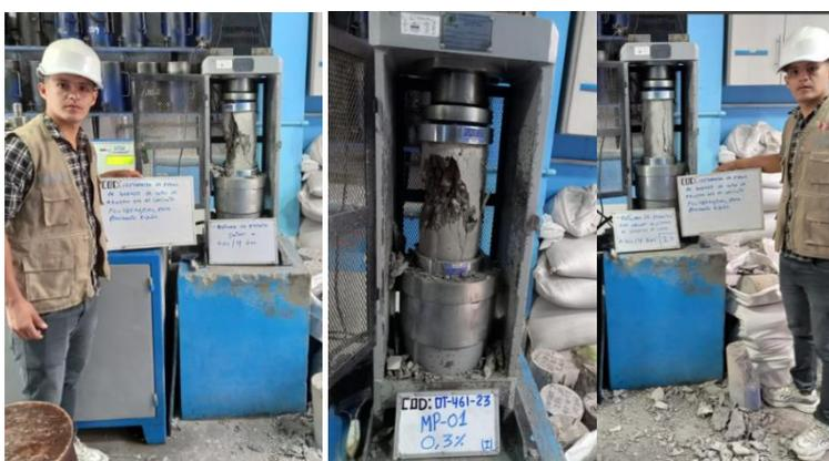
**figura 25:** ensayo de resistencia a la compresion
