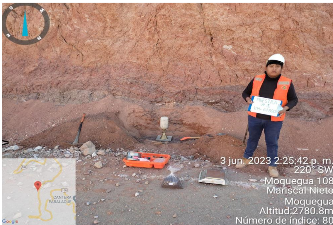
Ensayo de densidad en campo.
