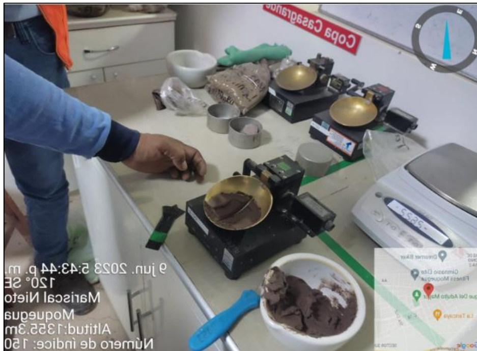
Figura 22. Copa de Casagrande Fuente: Elaboración propia.
