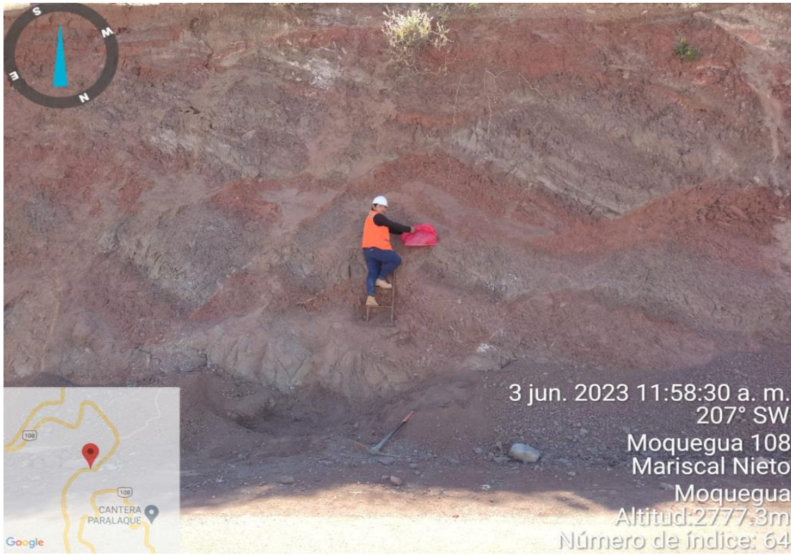
Recolección de muestra mediante trinchera parte media del talud.
