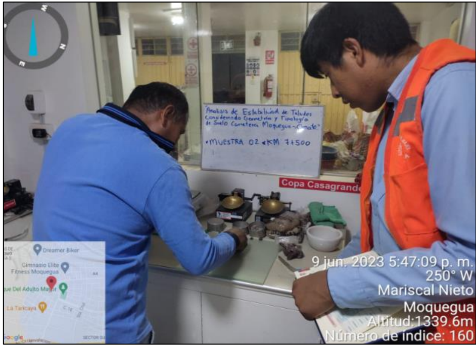
Figura 23. Ensayo de Limite plástico
