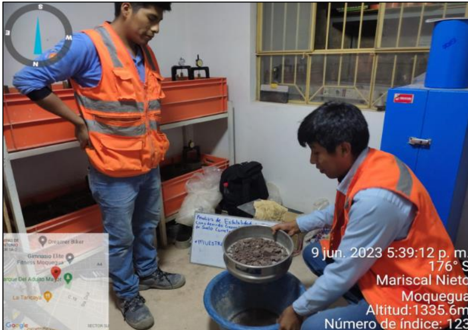
Figura 20. Tamizado de muestras
