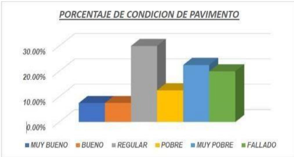
Figura 19 Proporción del estado actual del pavimento en las unidades de muestra Fuente: Elaboración propia.
