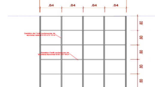
Estructura modular de aluminio Ver detalle 3
