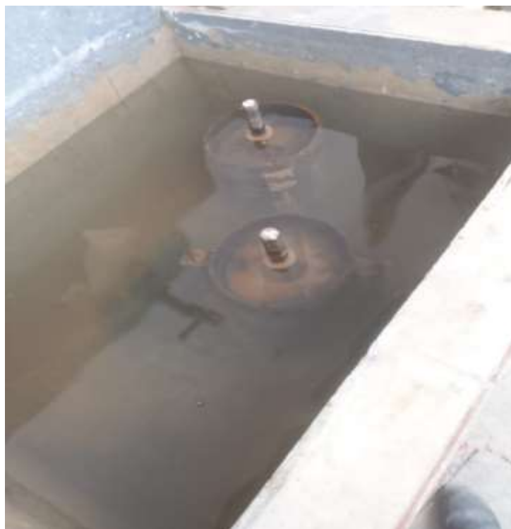
Fotografía 18: Moldes de CBR sumergidos en agua para la determinación del hinchamiento.
