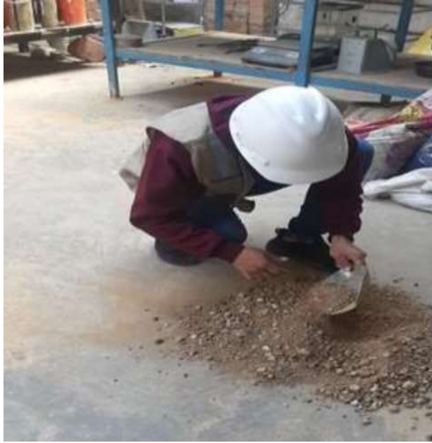
Fotografía 1: Mezcla homogénea del material para el cuarteo.
