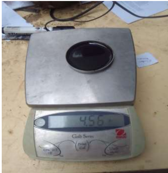
Fotografía 30: Peso del aceite reciclado para el ensayo de consolidación unidimensional.
