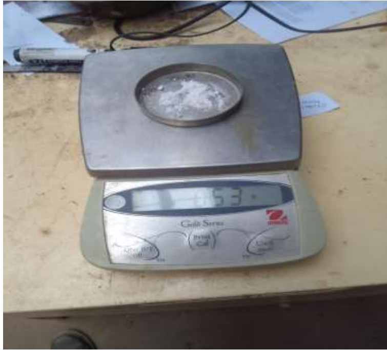
Fotografía 21: Peso de la cal para el ensayo de corte directo
