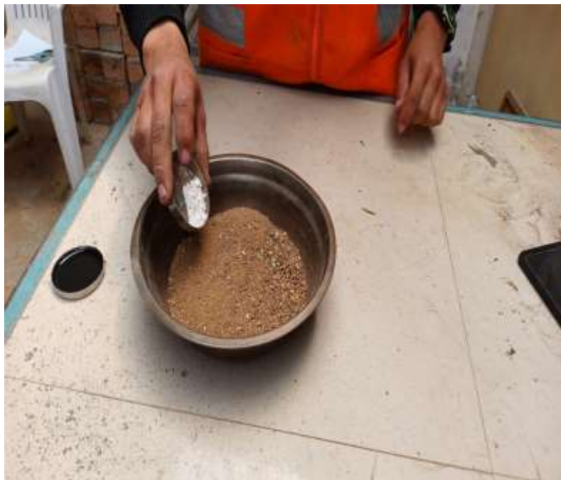
Fotografía 31: Adición de la cal y aceite reciclado a la muestra para el ensayo de consolidación unidimensional.
