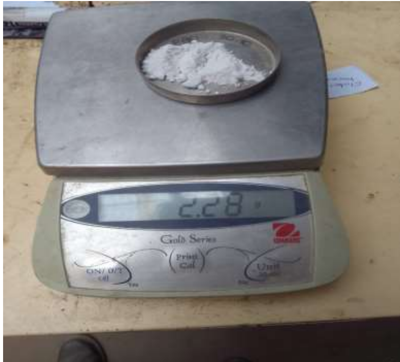
Fotografía 28: Peso de la cal para el ensayo de consolidación unidimensional.
