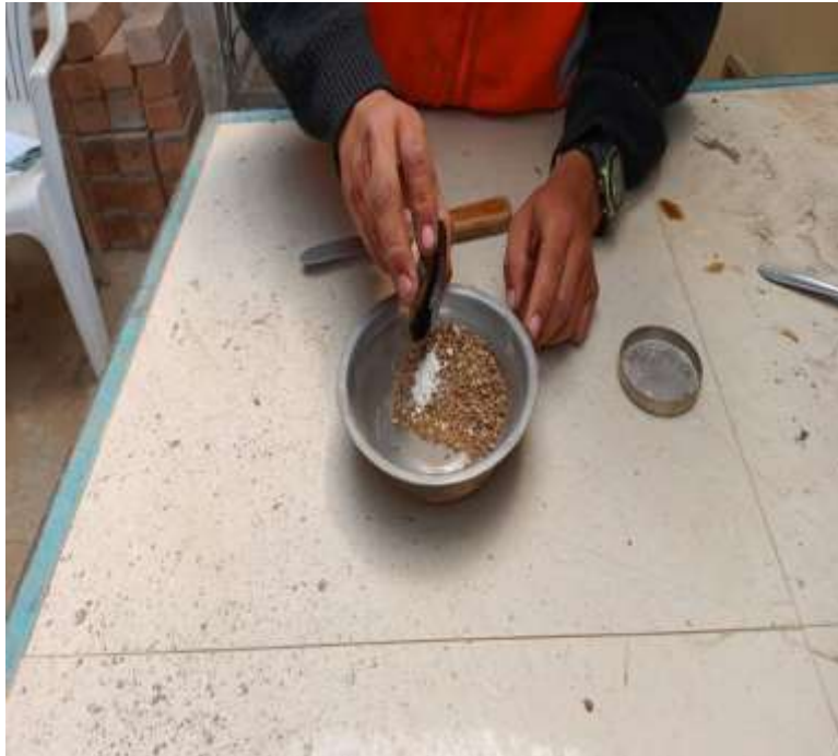
Fotografía 23: Adición de la cal y aceite reciclado a la muestra para el ensayo de corte directo.
