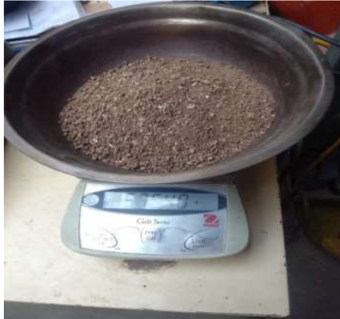
Fotografía 5: Peso de la muestra húmeda más recipiente para la determinación del contenido de humedad de la fracción de suelo que pasa el tamiz N°4
