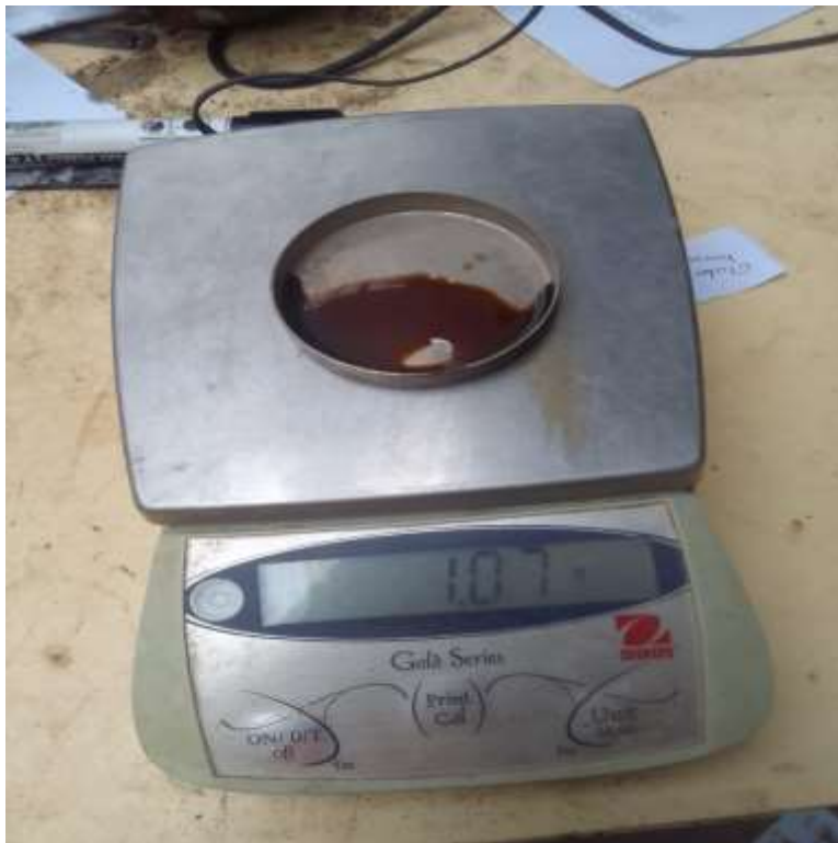
Fotografía 22: Peso del aceite reciclado para el ensayo de corte directo
