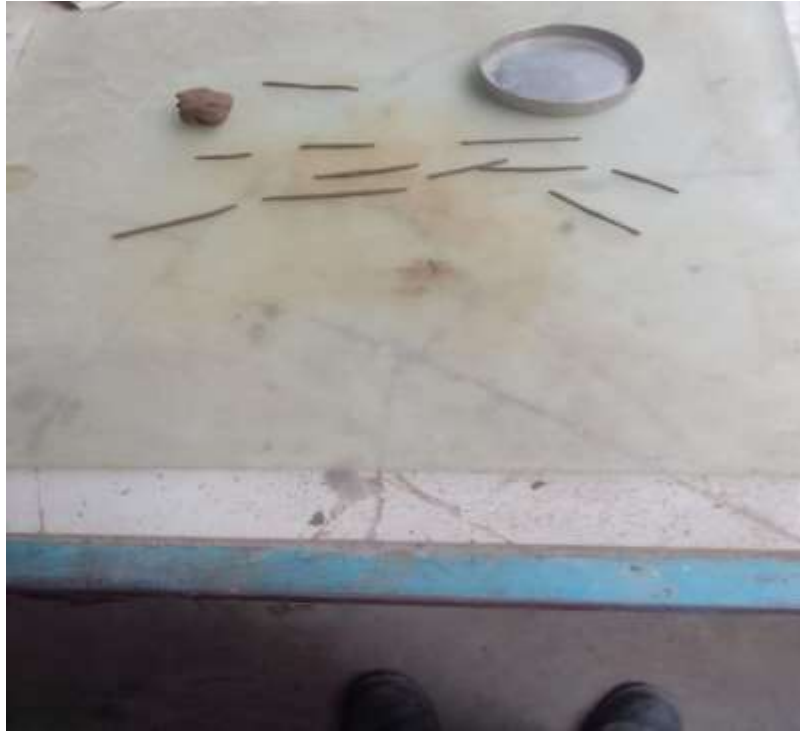
Fotografía 11: Rollitos formados del ensayo de límite plástico
