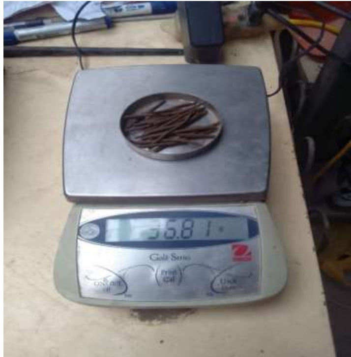
Fotografía 12: Peso del recipiente más muestra del ensayo de límite plástico
