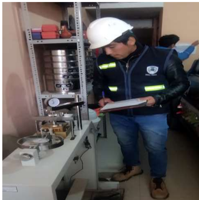
Fotografía 24: Realización del ensayo de corte directo.
