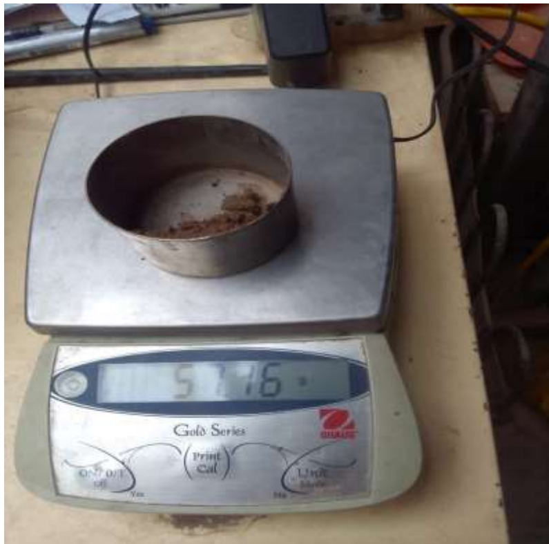
Fotografía 8: Peso del recipiente más muestra del ensayo de límite líquido
