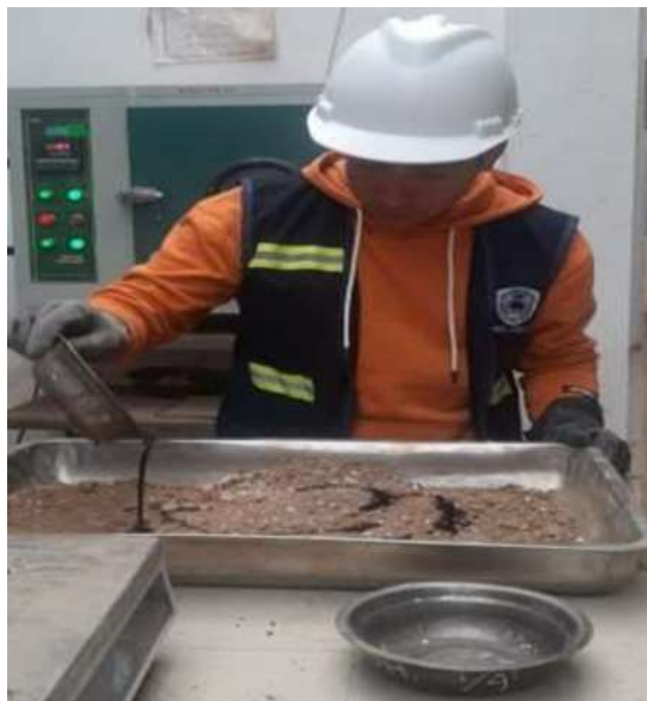
Fotografía 16: Adición de cal y aceite reciclado a la muestra de suelo para el ensayo CBR.
