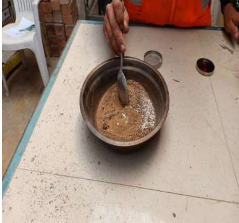
Fotografía 32: Combinación de la cal más aceite reciclado para el ensayo de consolidación unidimensional
