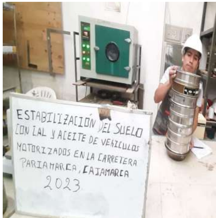
Fotografía 6: Realización de ensayo de análisis granulométrico
