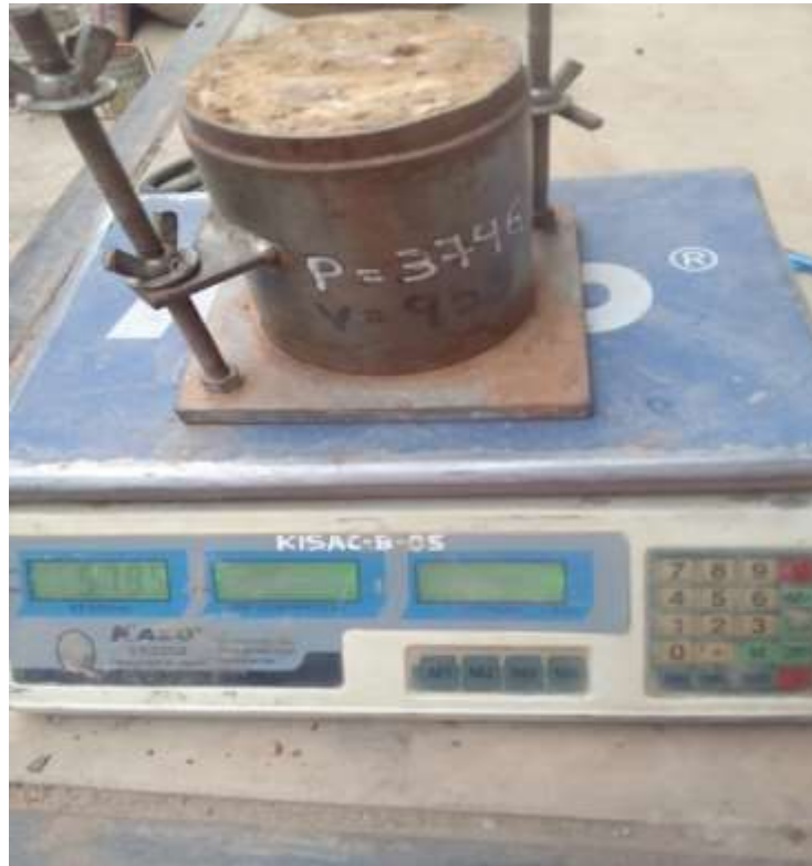
Fotografía 13: Peso del molde más muestra del ensayo de Proctor modificado.
