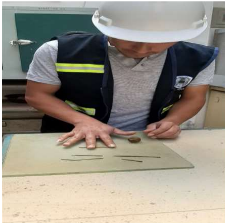
Fotografía 10: Realización del ensayo de límite plástico.
