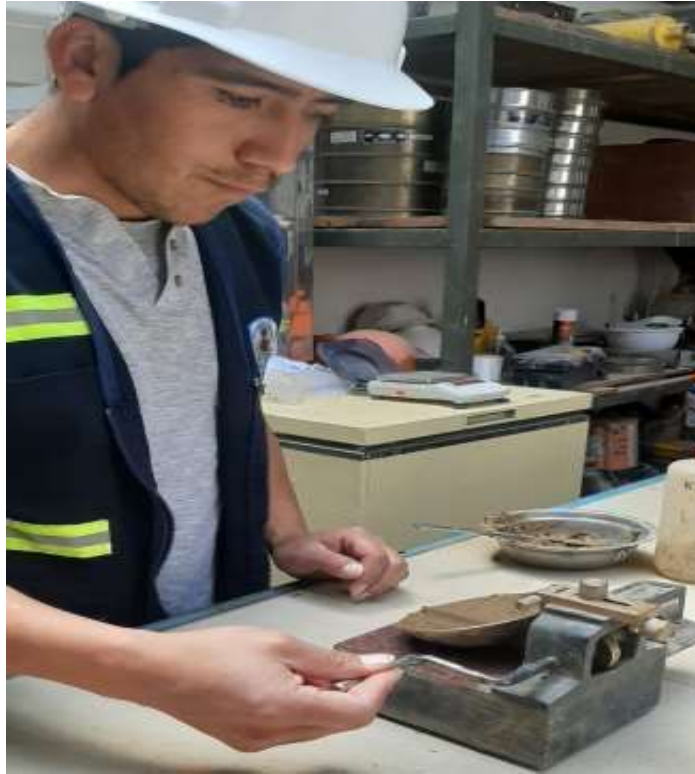
Fotografía 7: Realización del ensayo de límite líquido
