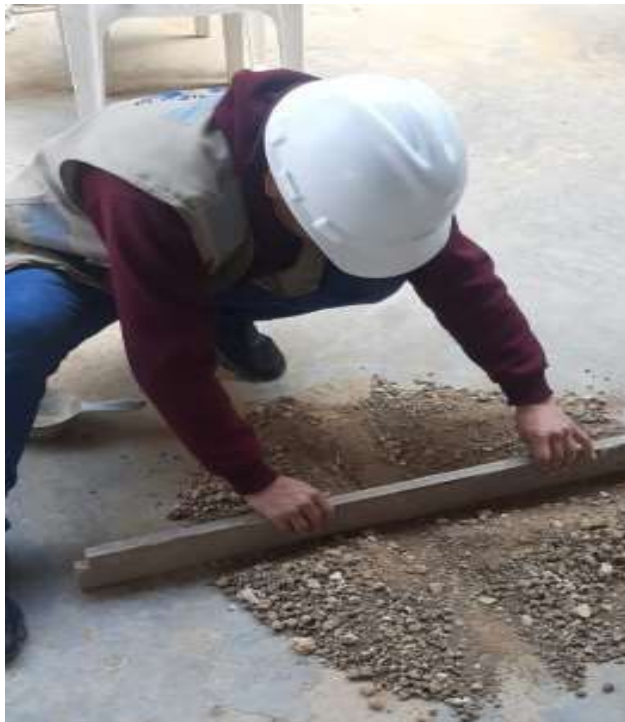
Fotografía 1: Mezcla homogénea del material para el cuarteo.
