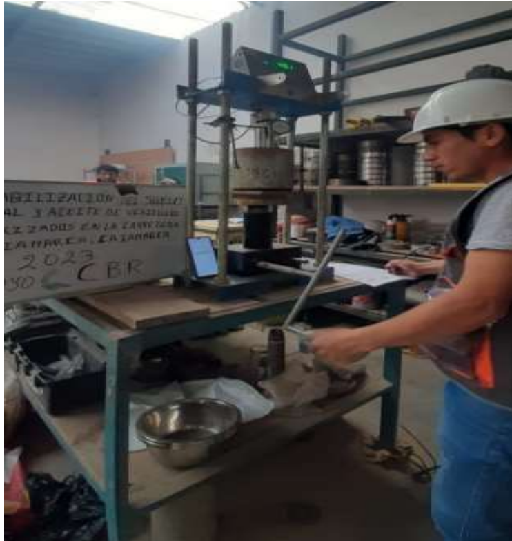
Fotografía 19: Realización del ensayo de penetración
