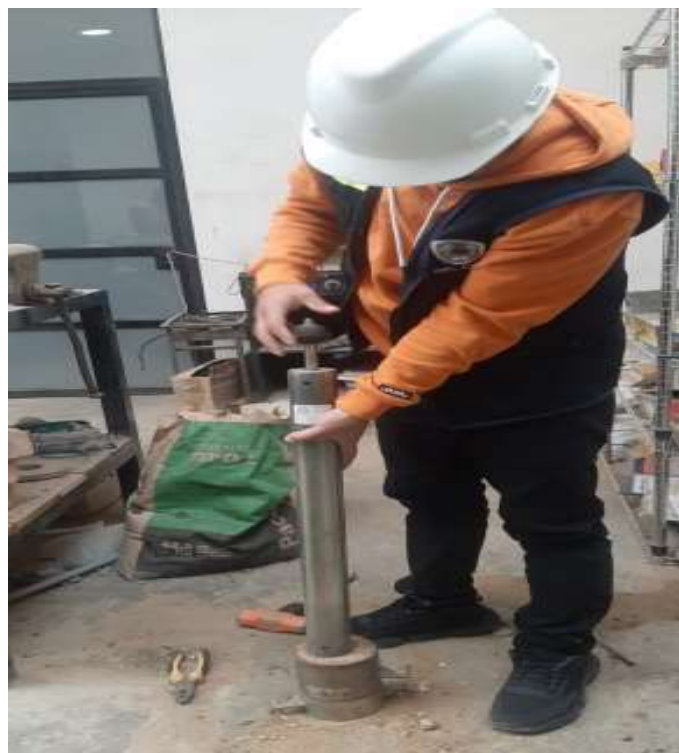
Fotografía 14: Extracción del material para la determinación del contenido de humedad del ensayo de Próctor modificado.
