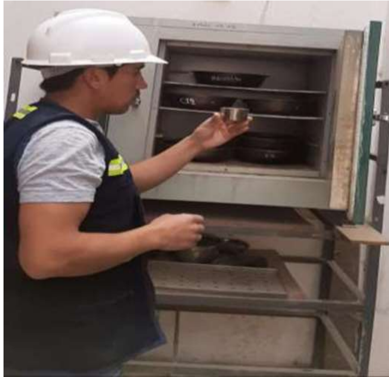
Fotografía 9: Colocación de la muestra en el horno para el ensayo de límite líquido.
