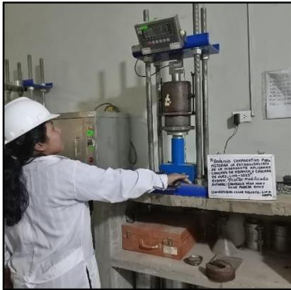
Ensayo CBR del suelo patrón + 15% conchas de abanico pulverizado
