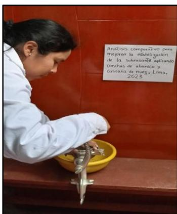
*Figura 24. Procedimiento del pulverizado de la concha de abanico*
