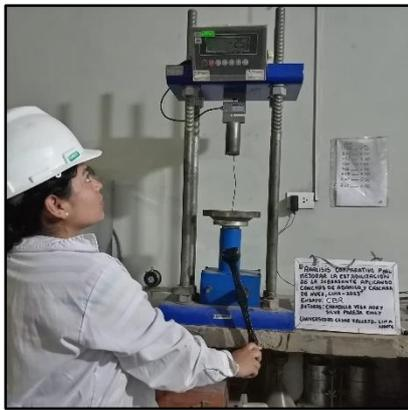
Ensayo CBR del suelo patrón + 35% conchas de abanico pulverizado
