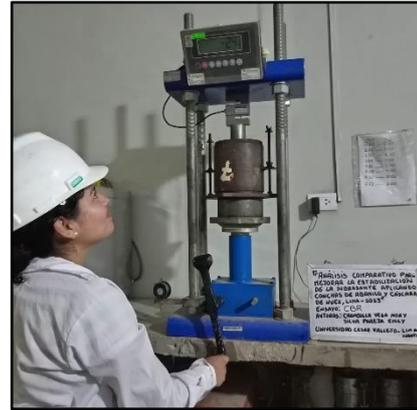
Ensayo CBR del suelo patrón + 25% conchas de abanico pulverizado
