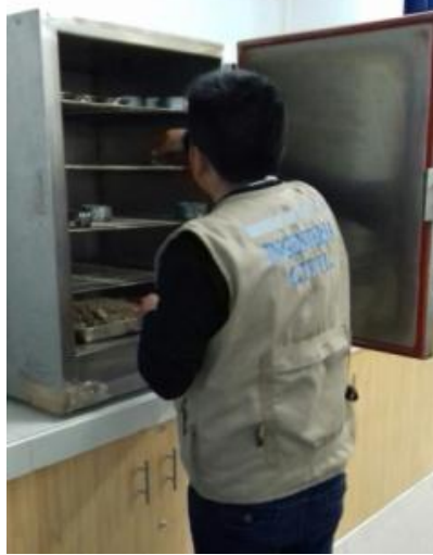
Figura 34 Ejecución del Ensayo de Contenido de Humedad
