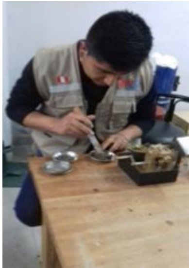
Figura 36 Ejecución del Ensayo de Limite Liquido en la copa de Casagrande
