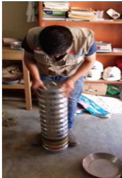
Figura 35 Ejecución del Ensayo de Granulometría
