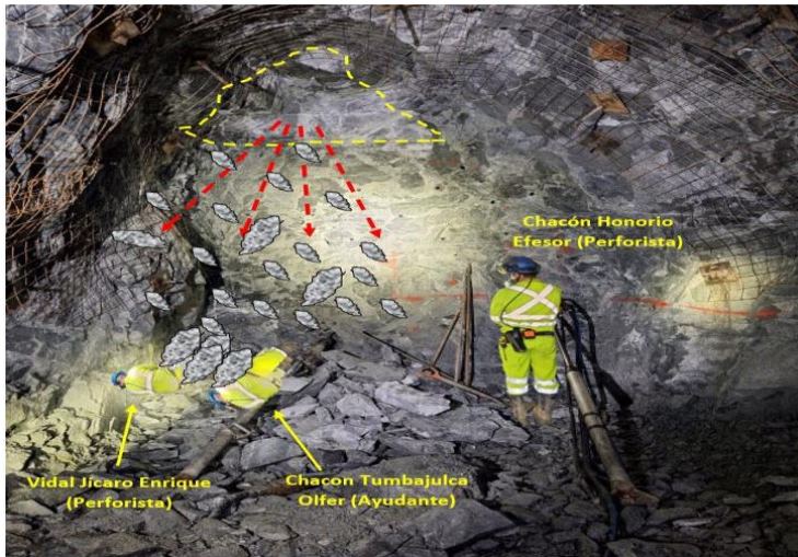
Figura 1. Accidente incapacitante por relajamiento de roca en mina de la localidad de Pataz (Alerta de seguridad, 2023)
