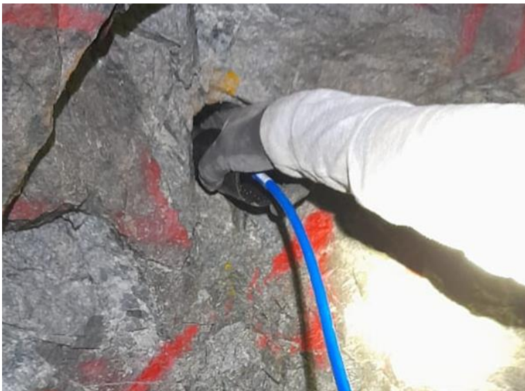
Figura 3. Ingreso de geófono triaxial en un taladro
