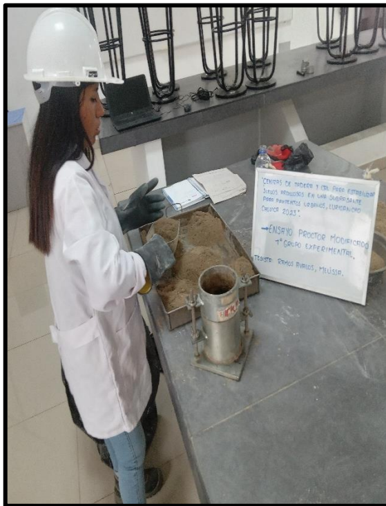
Figura 38: Colocación de la 1ra capa.
