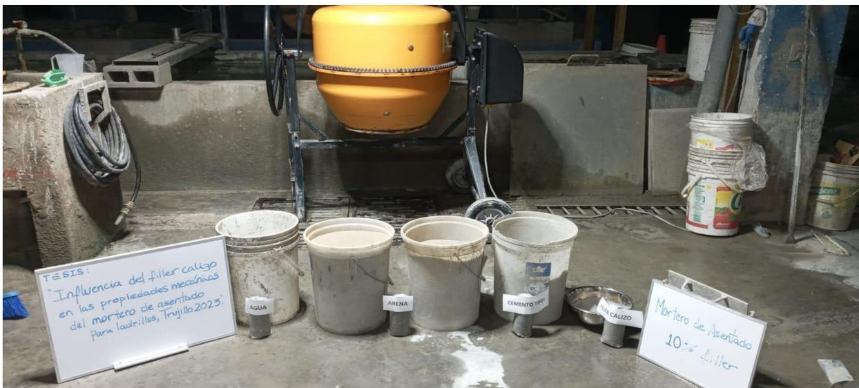
Figura 14. Dosificación para tanda de mortero con 10% de filler calizo.
