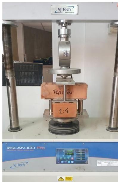
Figura 28. Ensayo de adherencia a la tracción directa.
