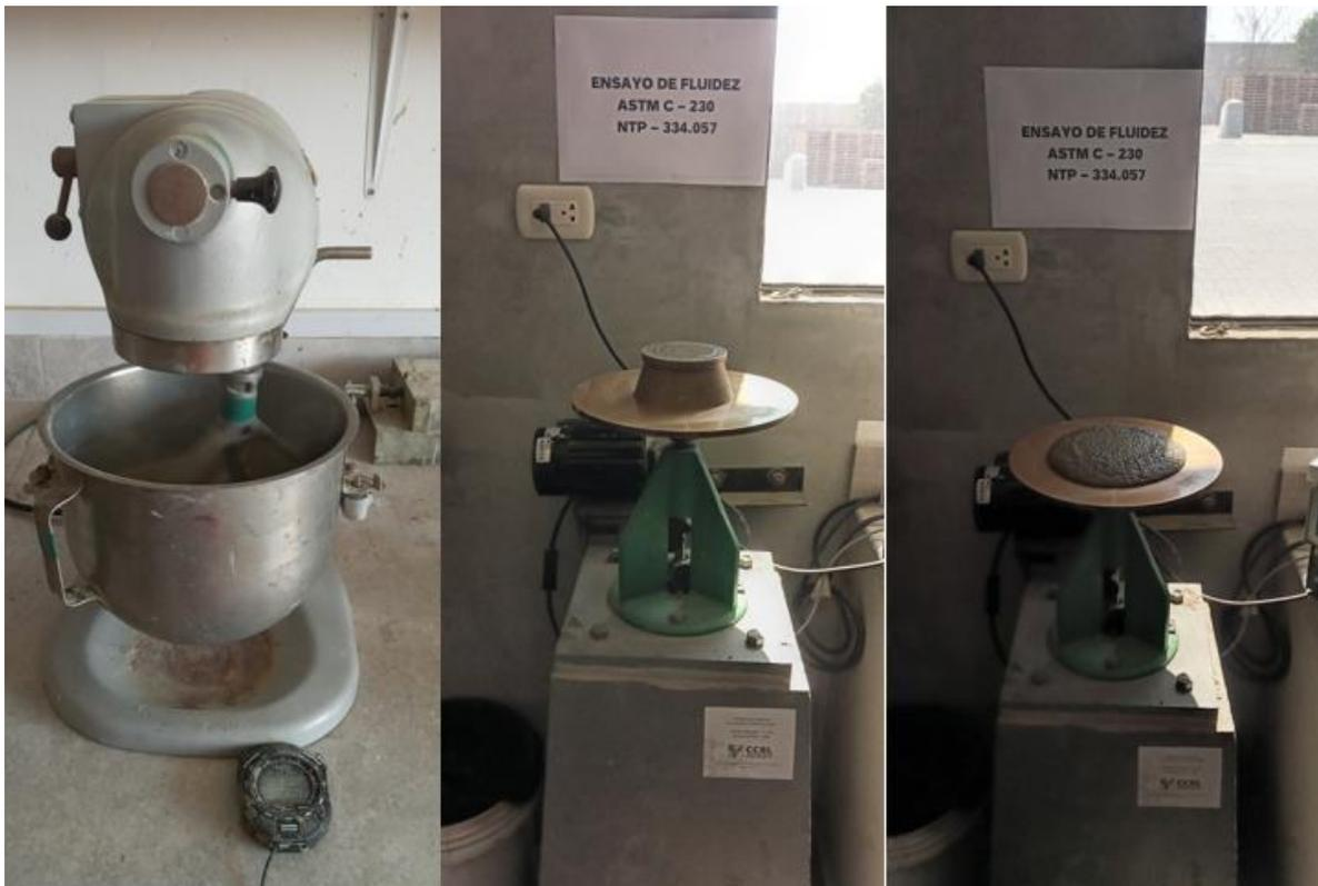
Figura 10. Ensayo de fluidez en mortero – ASTM C 305 / NTP-334.057.
