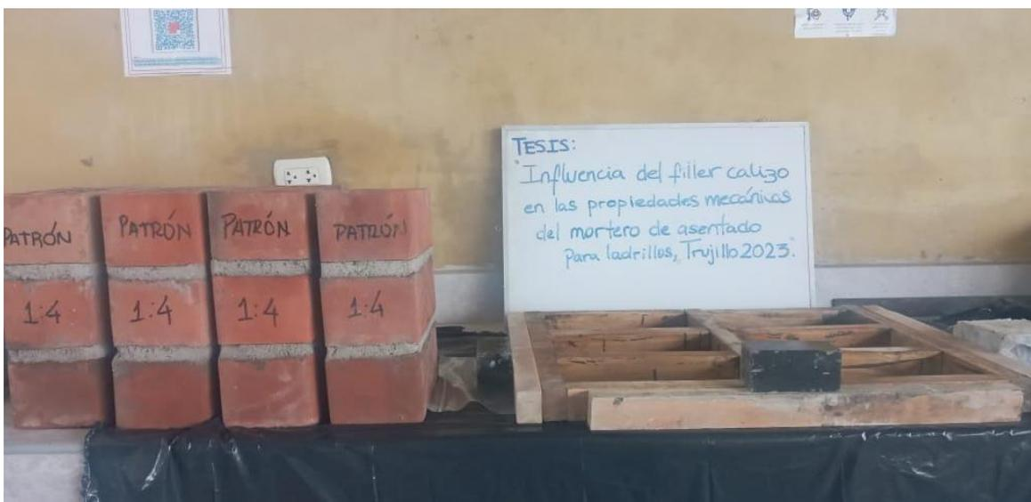
Figura 25. Pilas de albañilería para refrendado.
