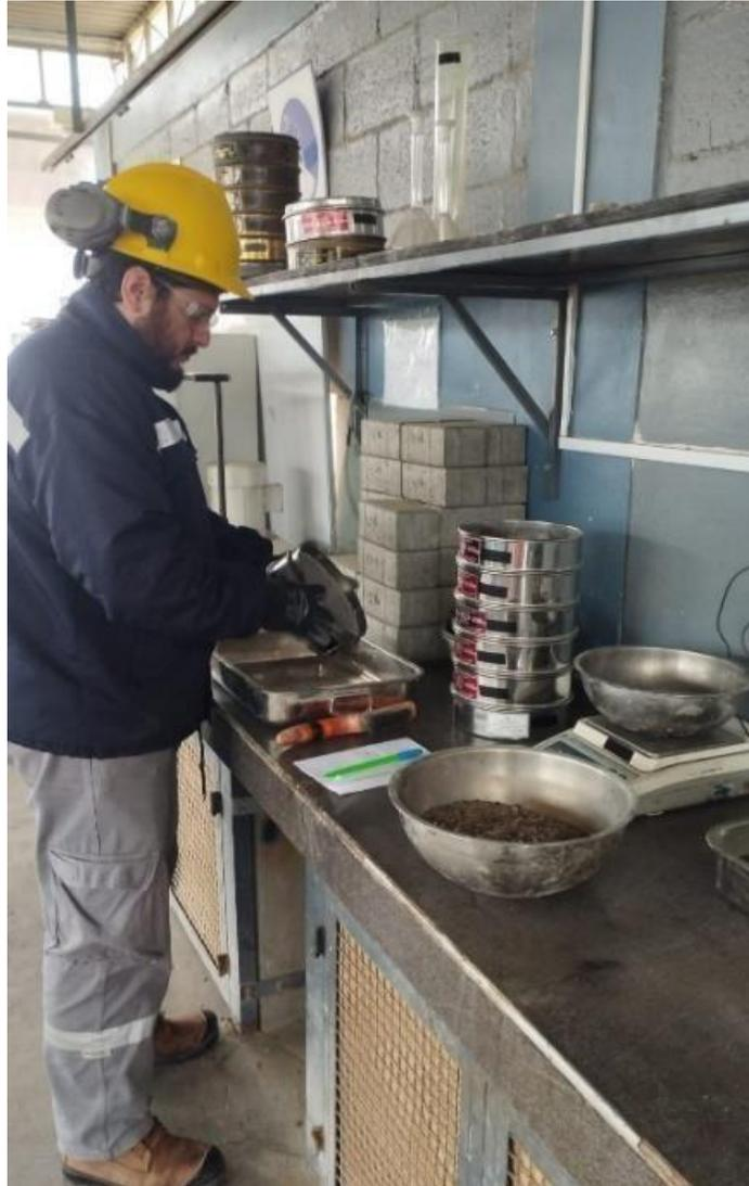
Figura 5. Ensayo de granulometría en agregado fino.
