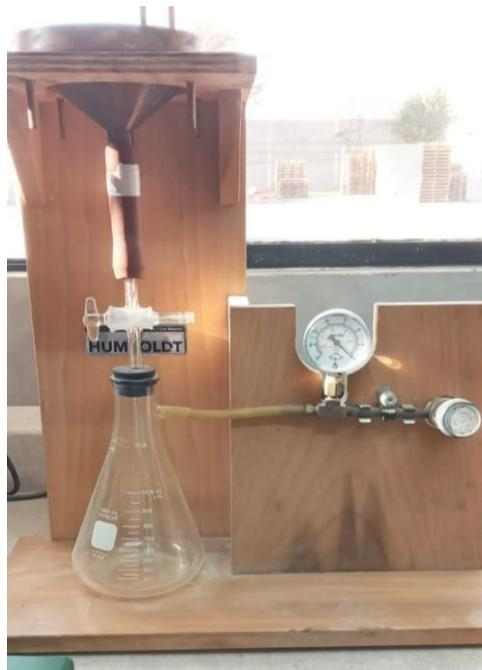
Figura 11. Equipo de retención de agua y regulador de vacío ASTM C110.
