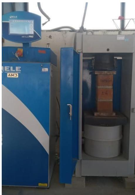
Figura 27. Ensayo de resistencia a la compresión en pilas de albañilería.
