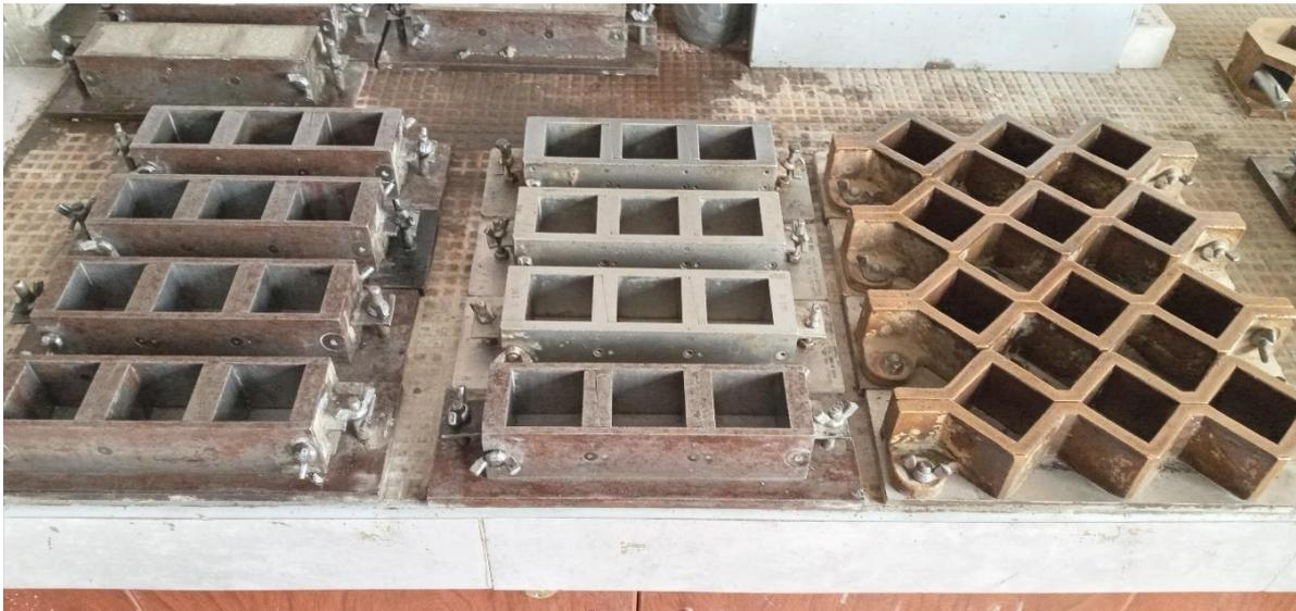
Figura 17. Moldes cúbicos para muestras de mortero.
