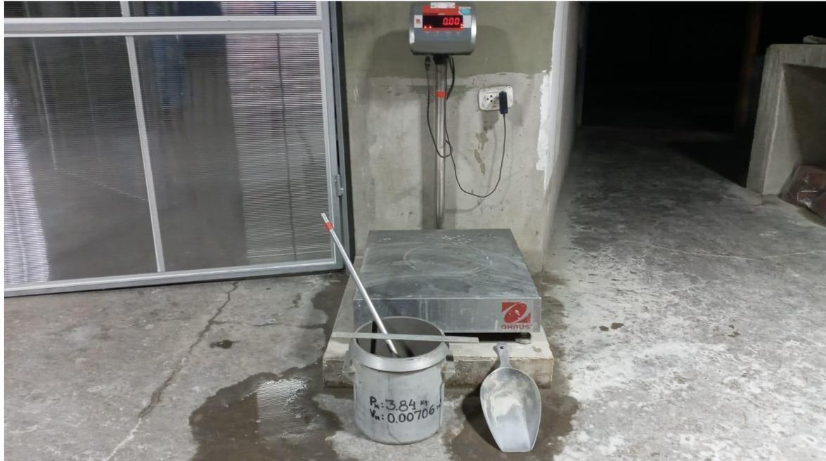
Figura 7. Herramientas y equipos para ensayo de PUC.
