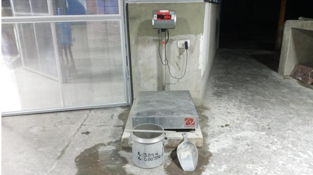
Figura 6. Herramientas y equipos para ensayo de PUS.
