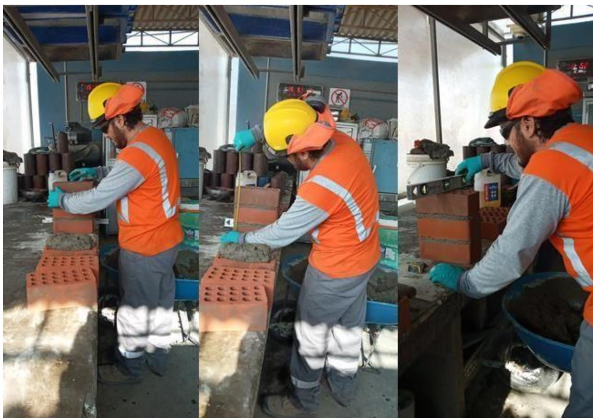
Figura 24. Elaboración de pilas de albañilería.
