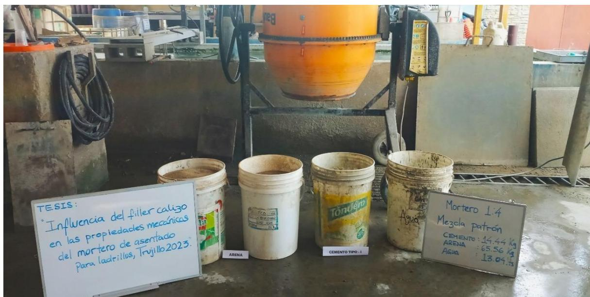
Figura 12. Dosificación para tanda de mortero patrón 1:4.
