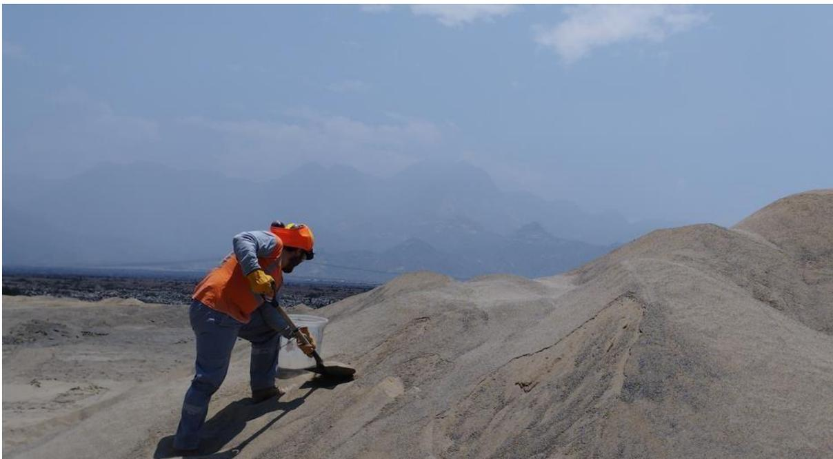
Figura 1. Muestreo de agregado fino en cantera Quebrada de León.
