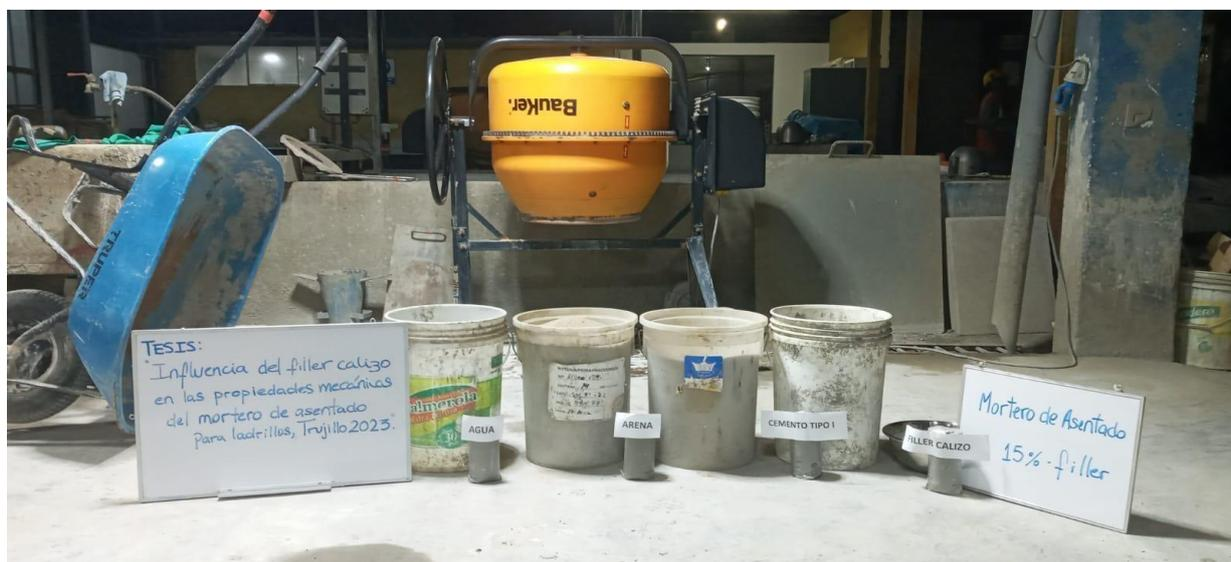
Figura 15. Dosificación para tanda de mortero con 15% de filler calizo.
