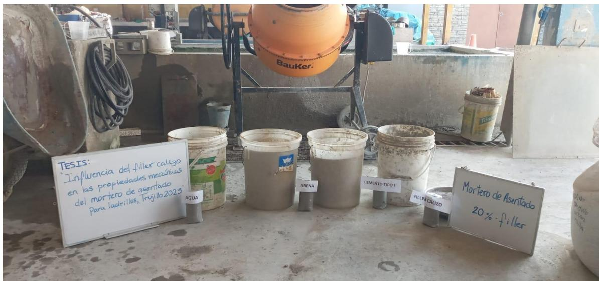
Figura 16. Dosificación para tanda de mortero con 20% de filler calizo.
