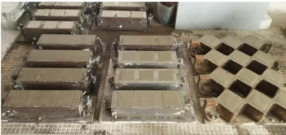
Figura 18. Elaboración de cubos para ensayo de resistencia a la compresión.
