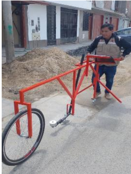
Figura 14: Ensayo de rugosidad – Calle 35
