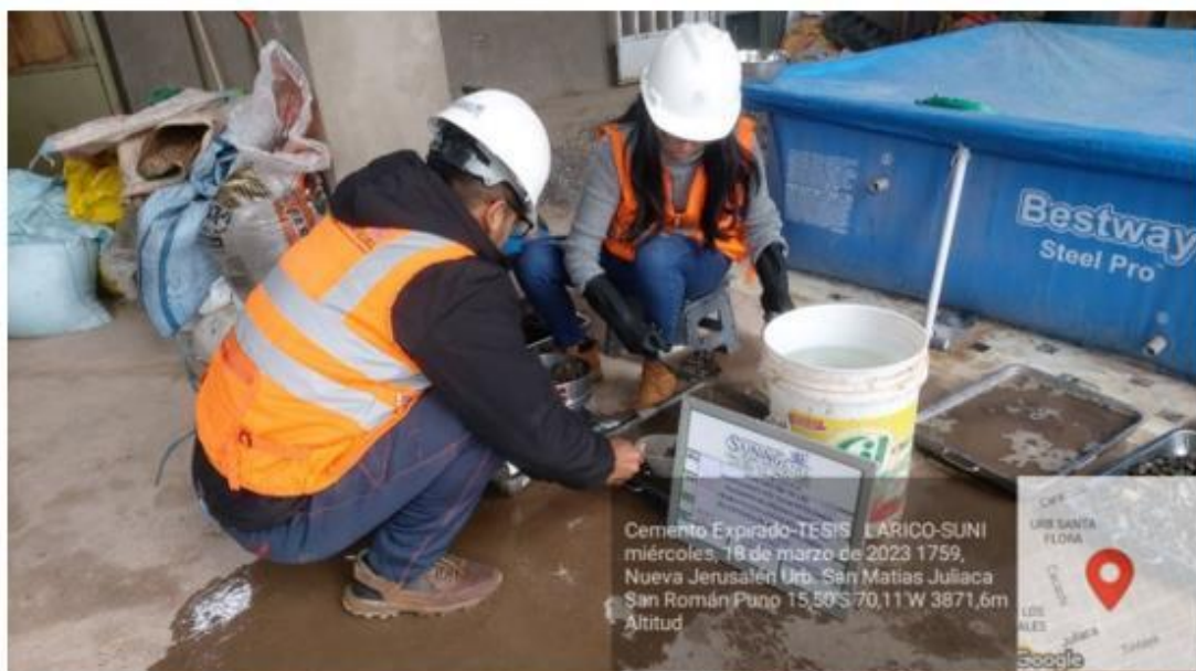
Fotografía 06. Lavado de Agregado Fino y Agregado Grueso Fuente. Elaboración Propia.
