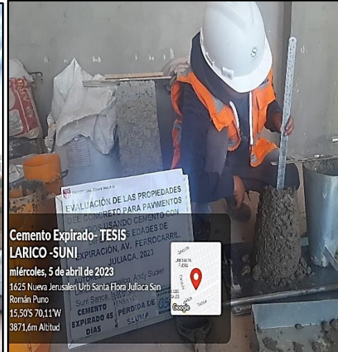
Figura 41. Medición del Slump Fuente. Elaboración propia
