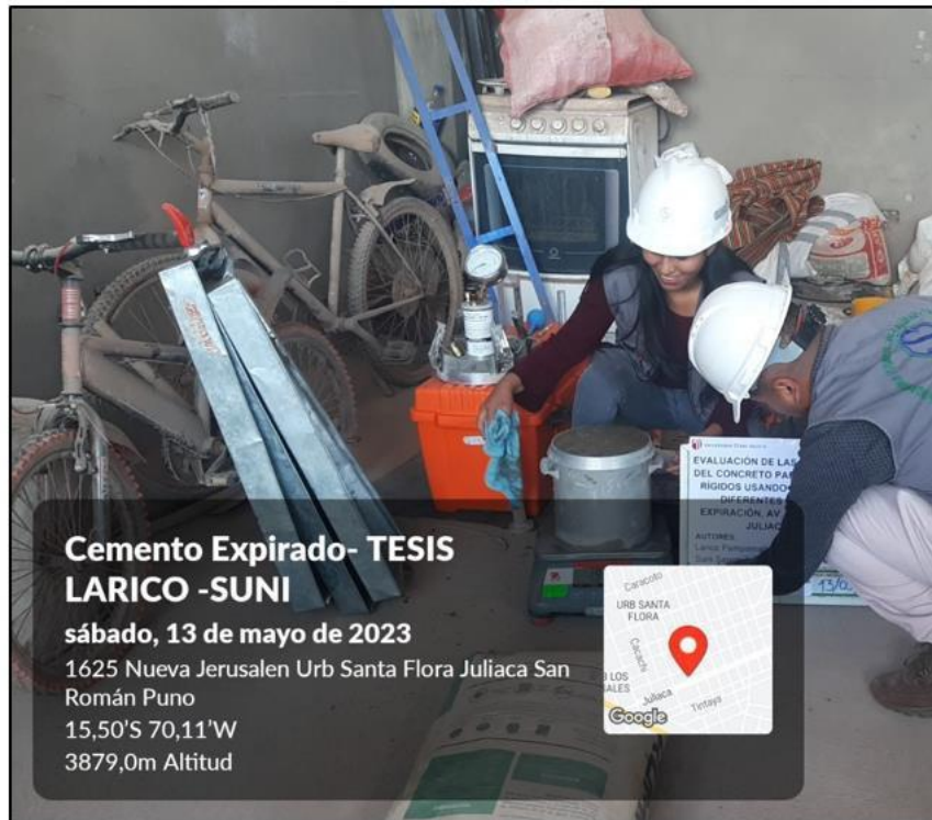
Fotografía 15. Peso específico del concreto
