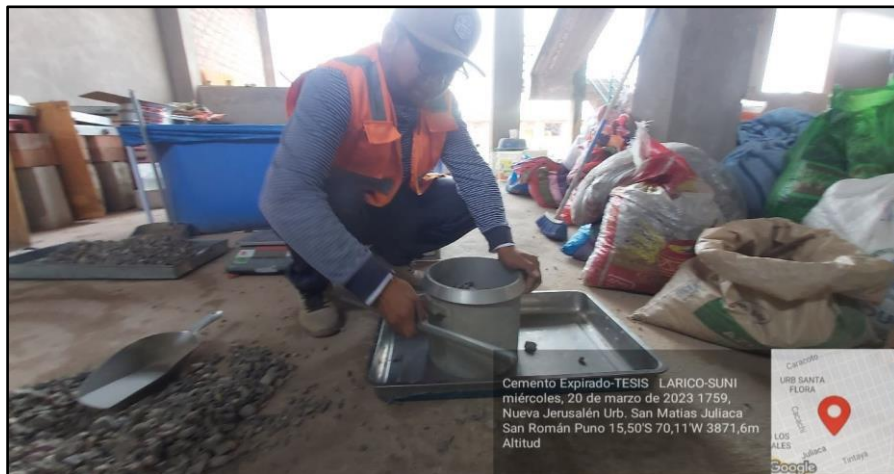
Figura 27. Llenado y varillado del agregado grueso para hallar el peso unitario.
