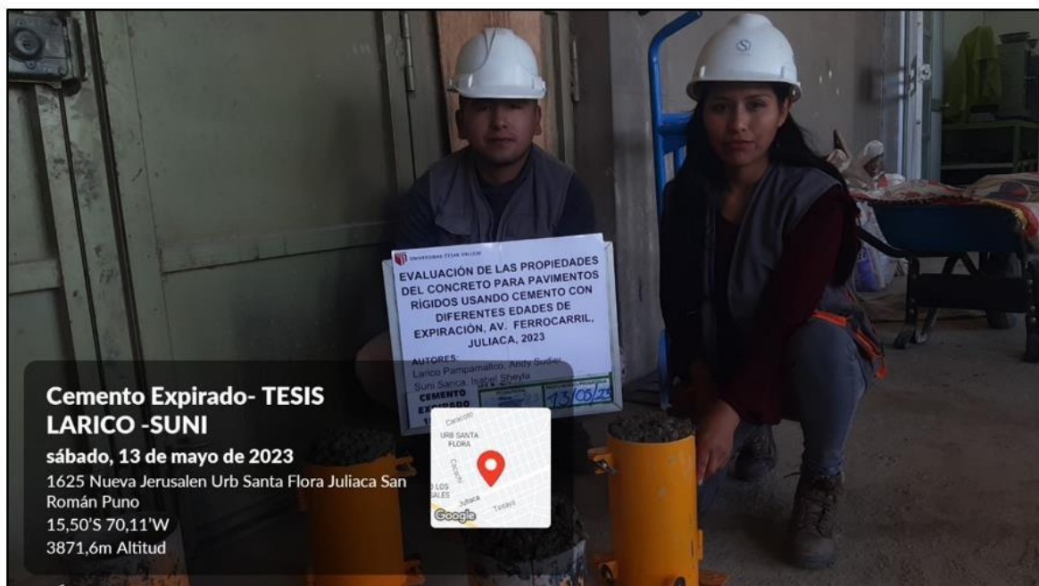
Fotografía 20. Elaboración de briquetas para la resistencia a la compresión.
