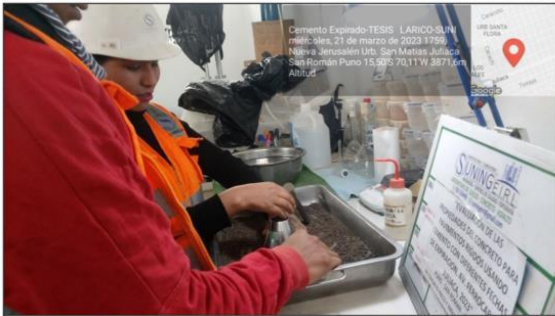
Fotografía 07. Ensayo para determinar la gravedad específica y la absorción. Fuente. Elaboración Propia.
