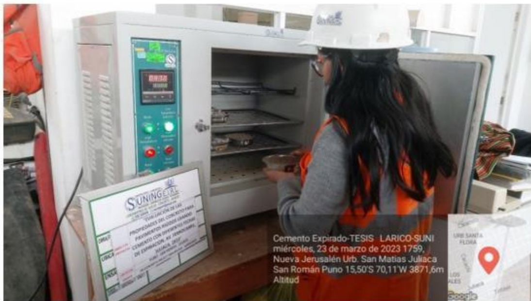
Fotografía 09. Secado de agregados con horno. Fuente. Elaboración Propia.
