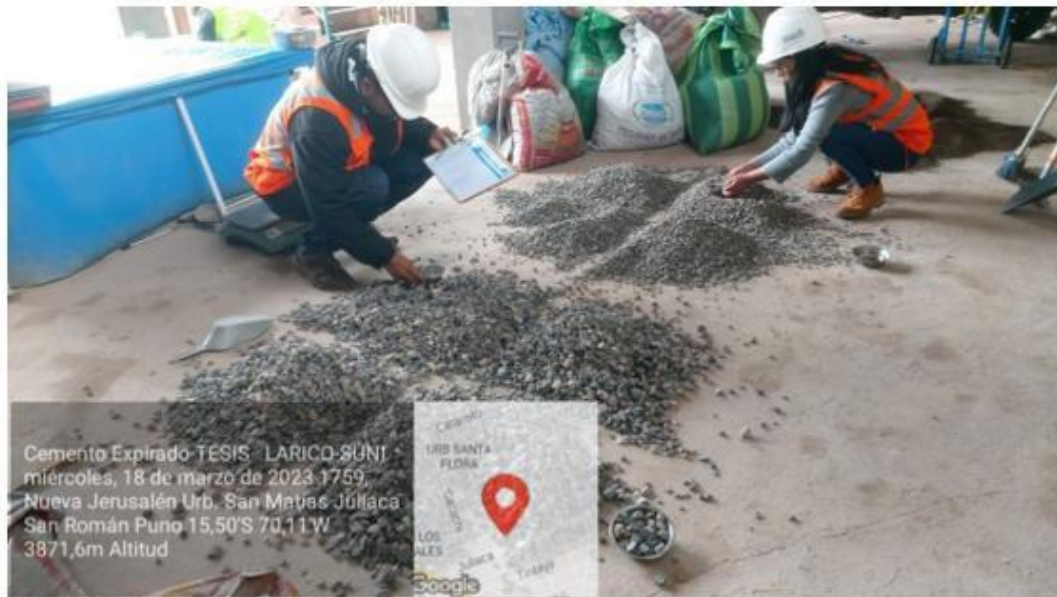
Fotografía 05. Cuarteo de Agregado Grueso – piedra chancada. Fuente. Elaboración Propia.
