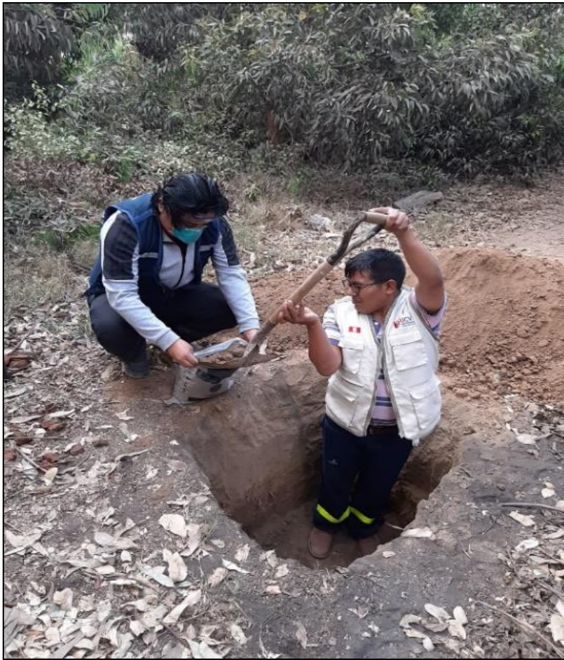
Sacado de muestras: Calicatas para el estudio de mecánica de suelos.
