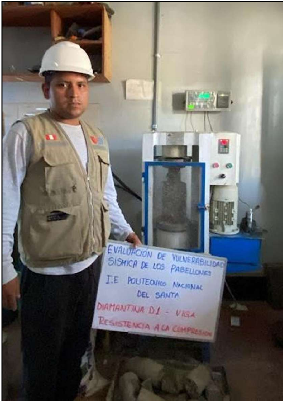
FOTOGRAFIA N° 22. COLOCACION DE DIAMANTINA N°1 PARA EL ENSAYO DE ROTURA
