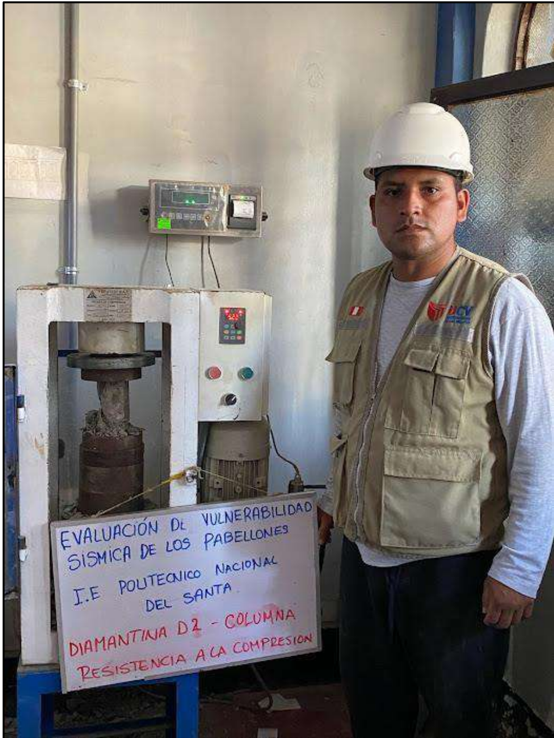
FOTOGRAFIA N° 24. COLOCACION DE DIAMANTINA N°2 PARA EL ENSAYO DE ROTURA
