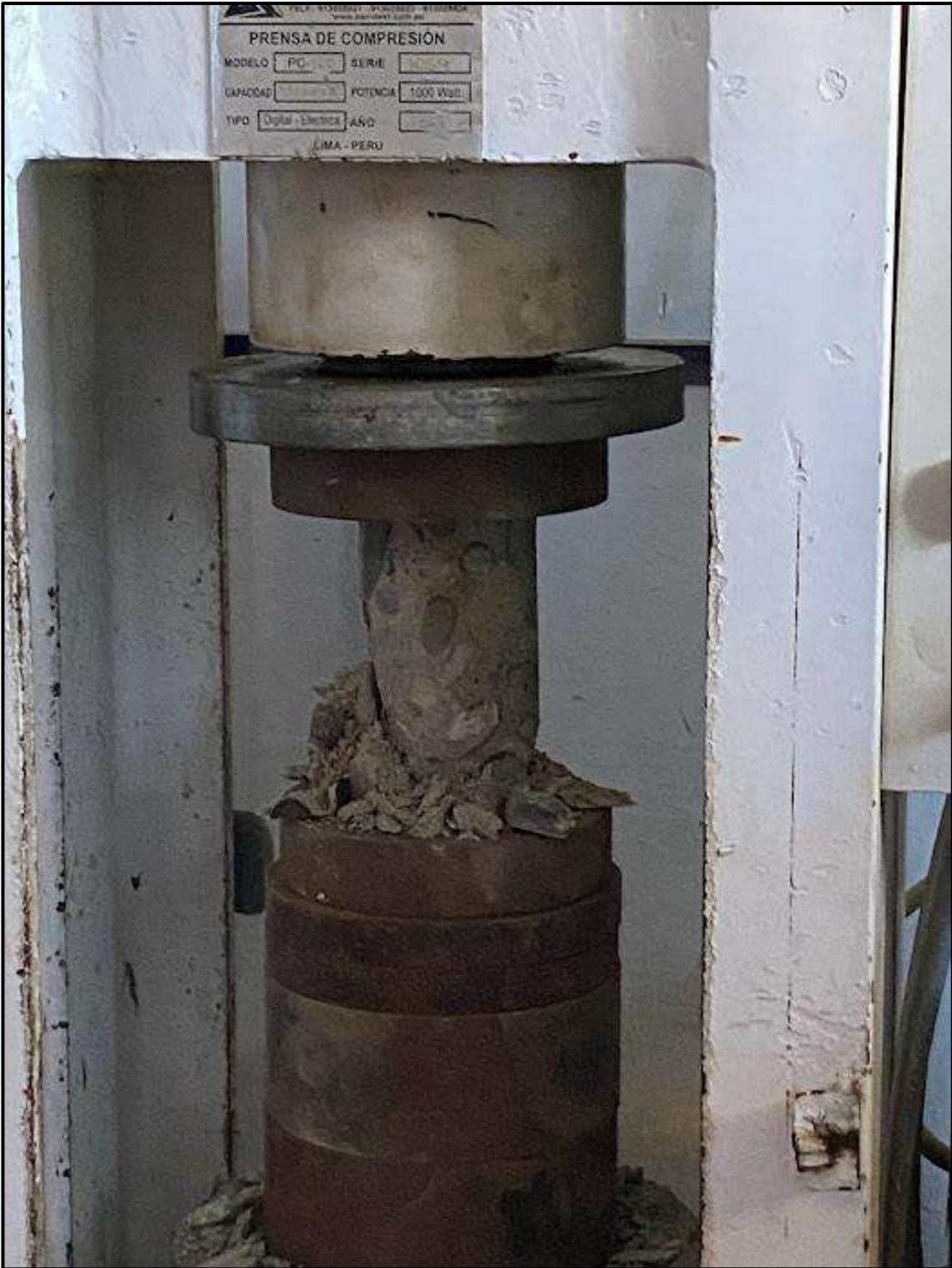
FOTOGRAFIA N° 25. ROTURA DE DIAMANTINA N°2
