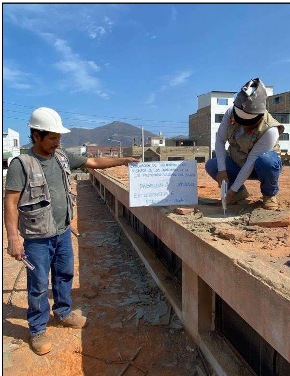
FIGURA N° 3 ENSAYO DE ESCLEROMETRIA
