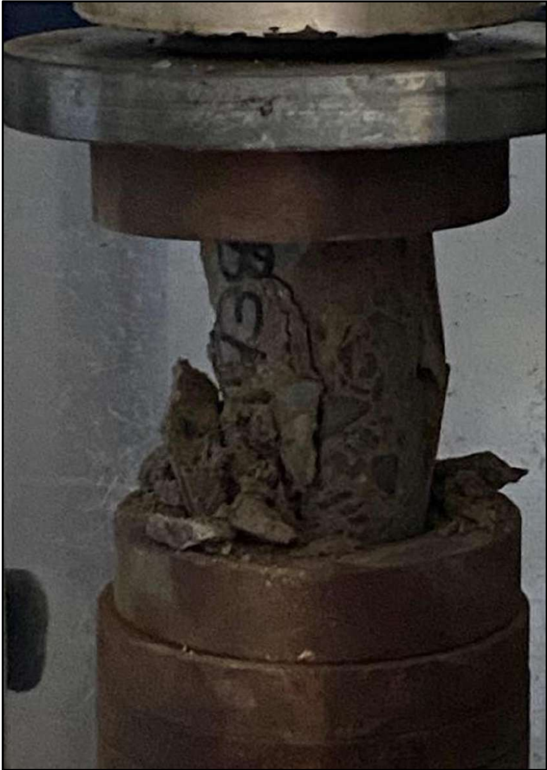
FOTOGRAFIA N° 23. ROTURA DE DIAMANTINA N°1
