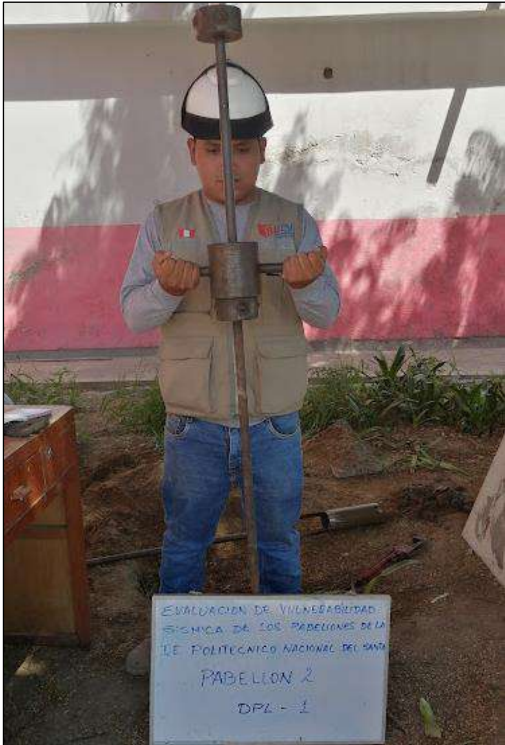
FIGURA N° 6 ENSAYO DE DPL
