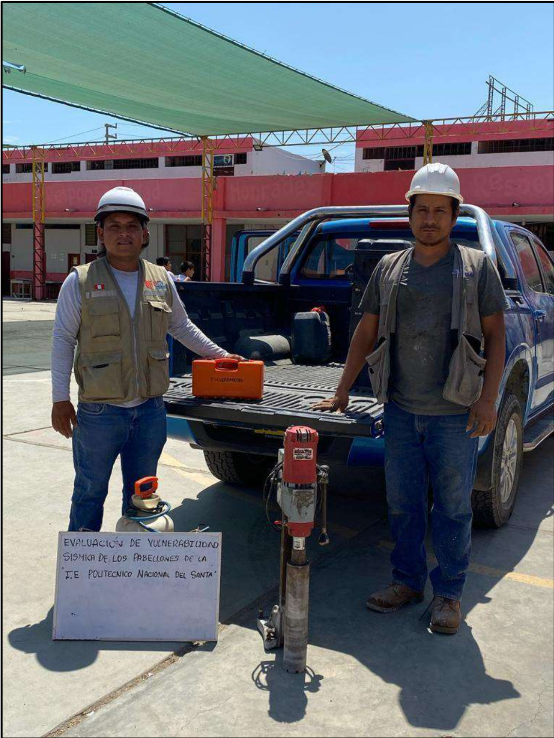
FOTOGRAFIA N° 16. INSTRUMENTO PARA LA EXTRACCION DE DIAMANTINAS
