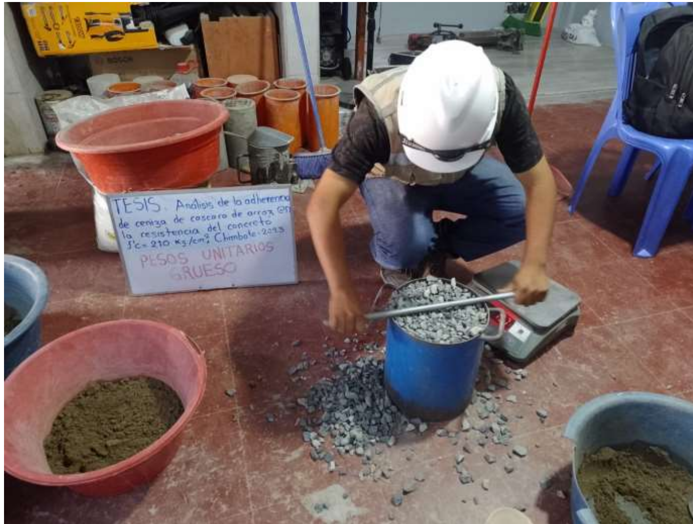
Imagen 8: Estudiante realizando los pesos unitarios y absorción de agregado grueso.
