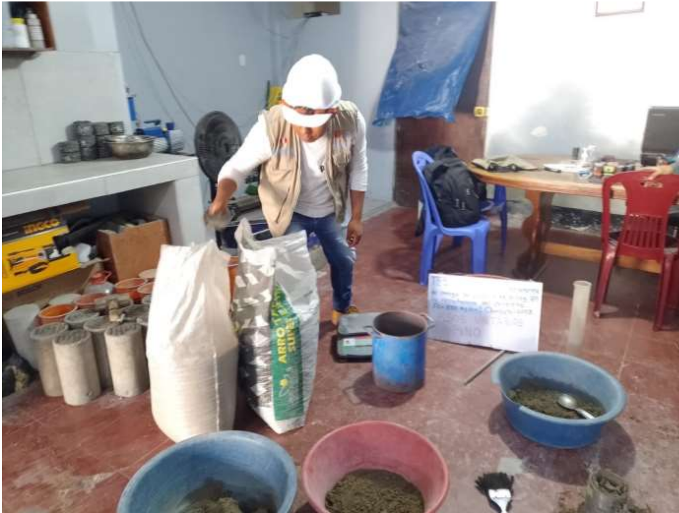
Imagen 4: Estudiante realizando los pesos unitarios de agregado fino.
