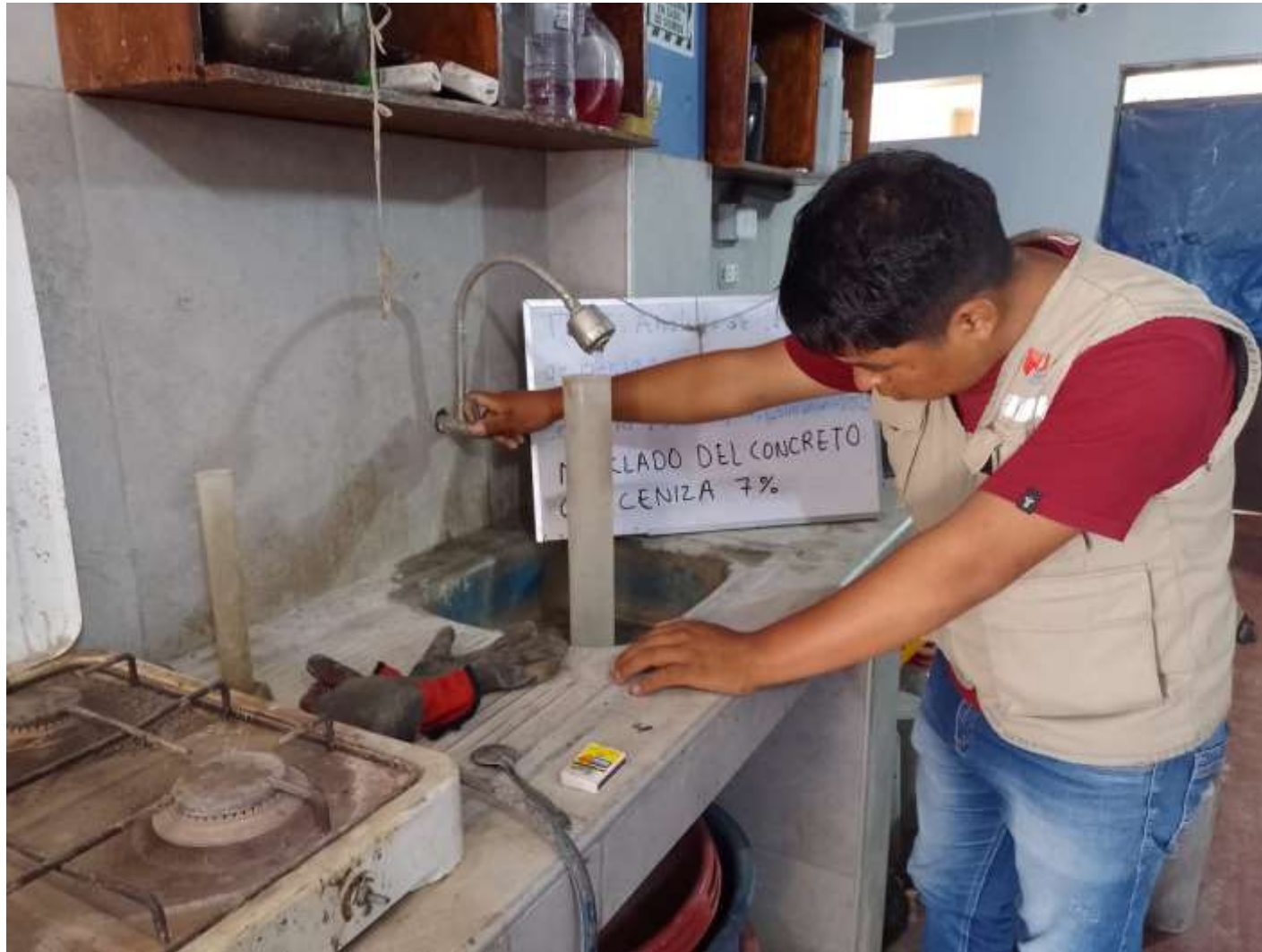
Imagen 14: Estudiante realizando el mezclado de agua, ceniza 7%
