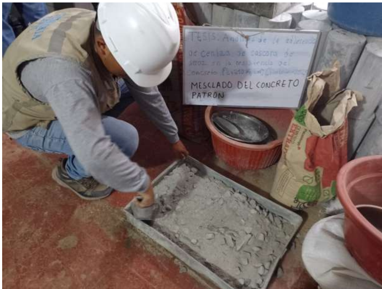
Imagen 12: Estudiante realizando el mezclado de concreto patrón.
