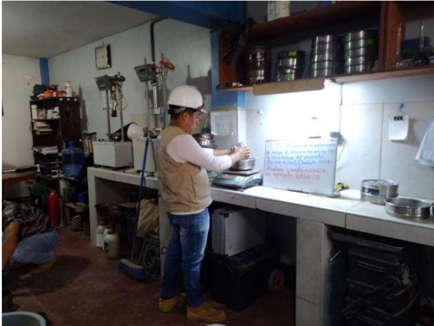
Imagen 2: Estudiantes realizando la granulometría de agregado grueso.
