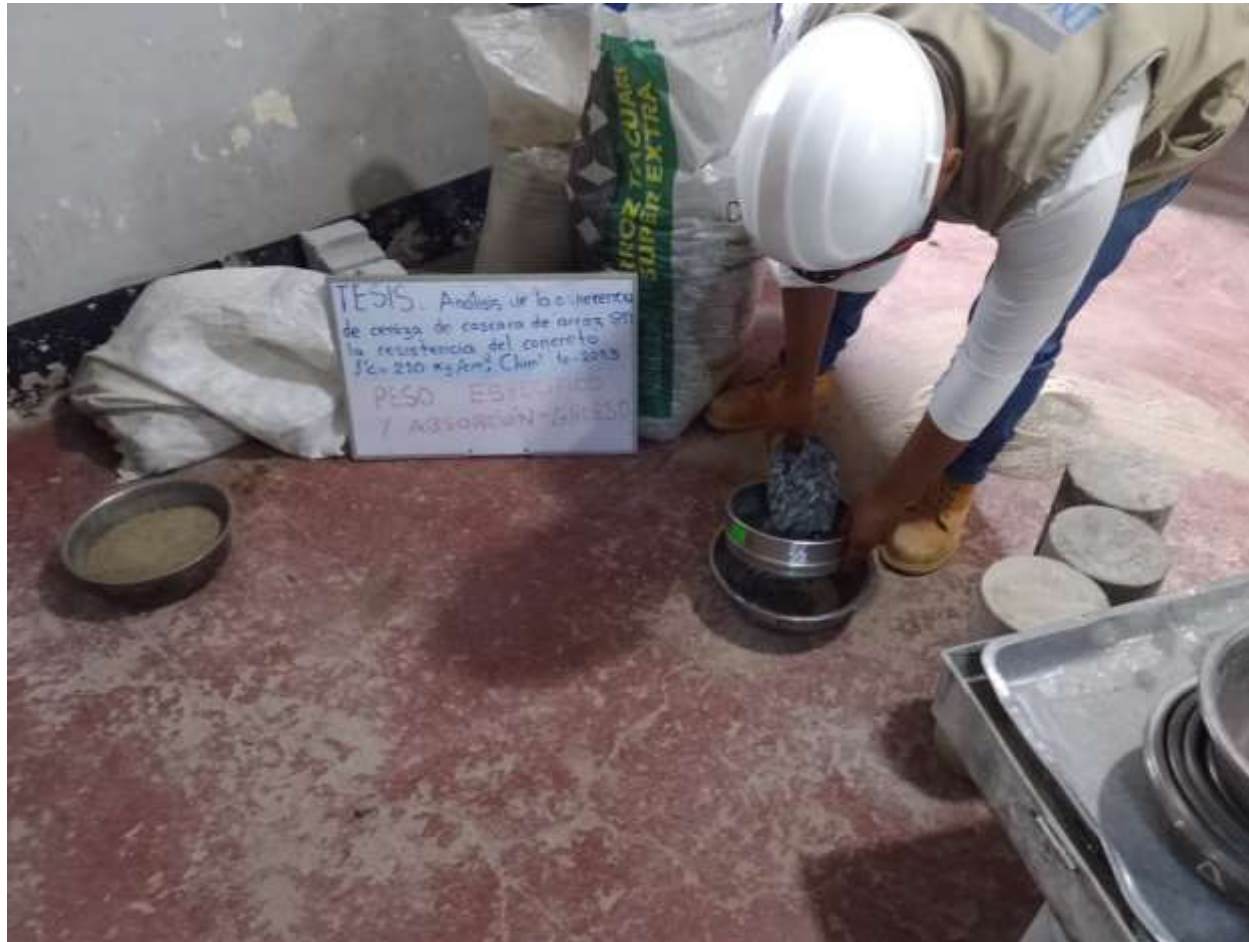
Imagen 9: Estudiante realizando los pesos unitarios y absorción de agregado grueso.
