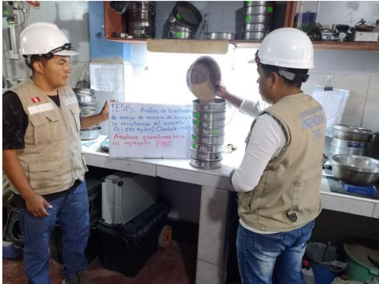
Imagen 1: Estudiantes realizando la granulometría de agregado fino.
