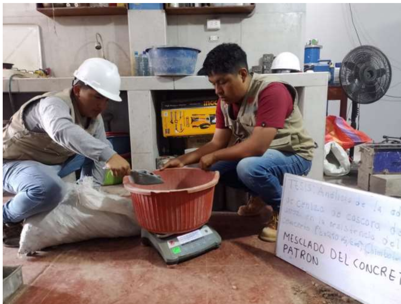
Imagen 13: Estudiante realizando el mezclado de concreto patrón.
