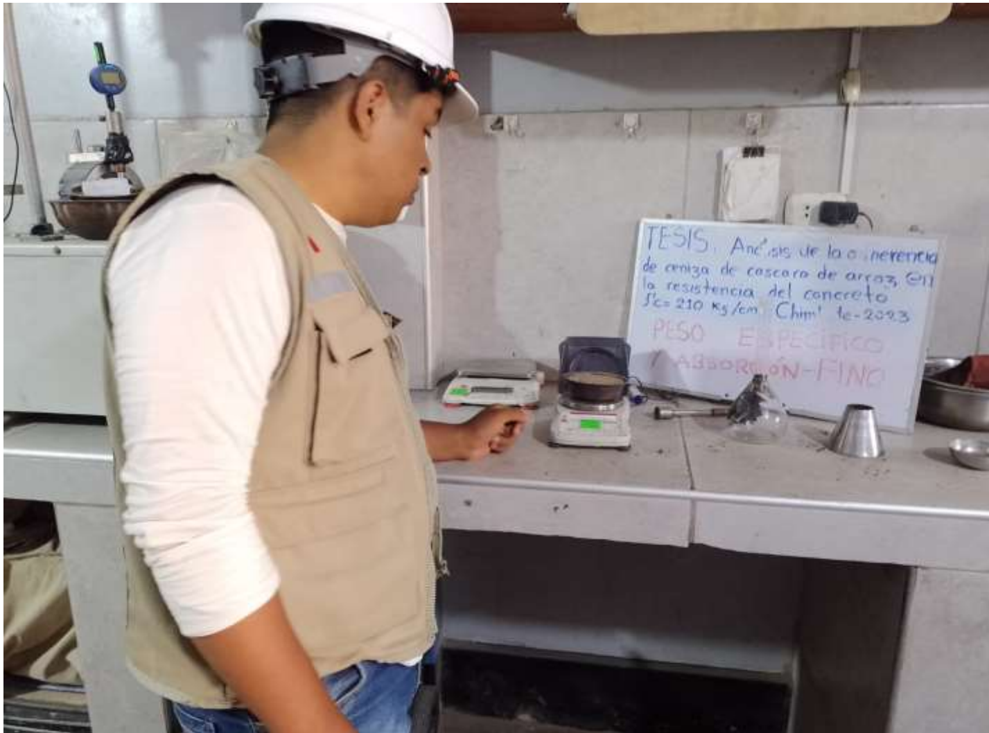
Imagen 11: Estudiante realizando los pesos específicos y absorción de agregado fino.
