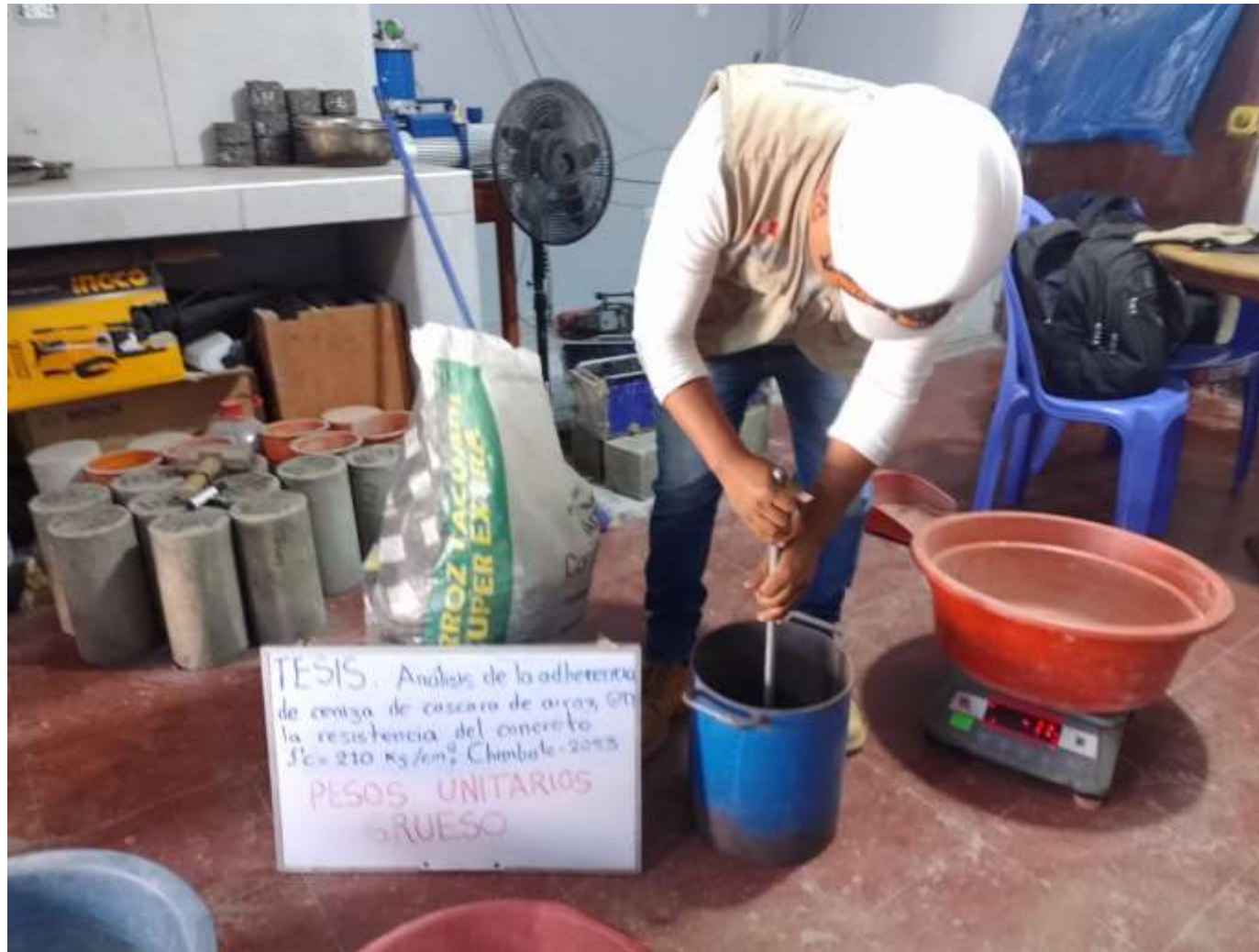
Imagen 6: Estudiante realizando los pesos unitarios de agregado grueso.
