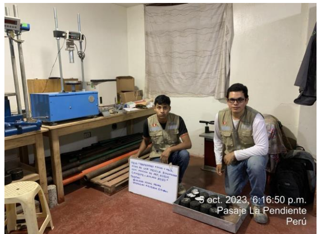
Ilustración 20. Briquetas de muestra patrón y con adición de 5%, 5.5% y 6% de PET ensayadas en el aparato Marshall
