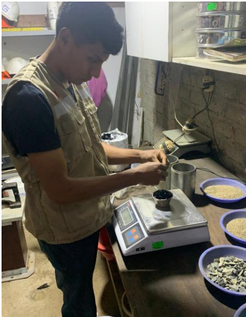
Ilustración 7. Pesado del Cemento Asfáltico
