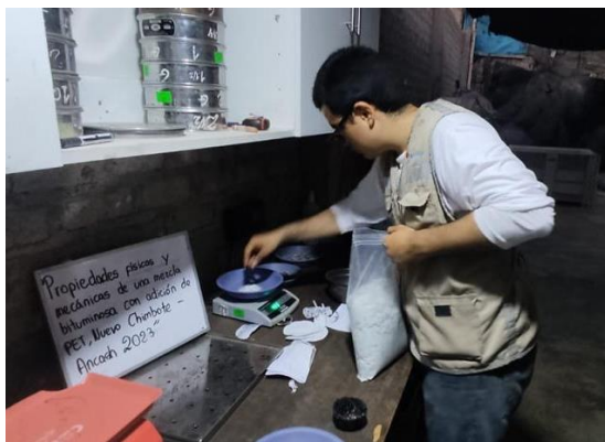
Ilustración 8. Pesado del PET
