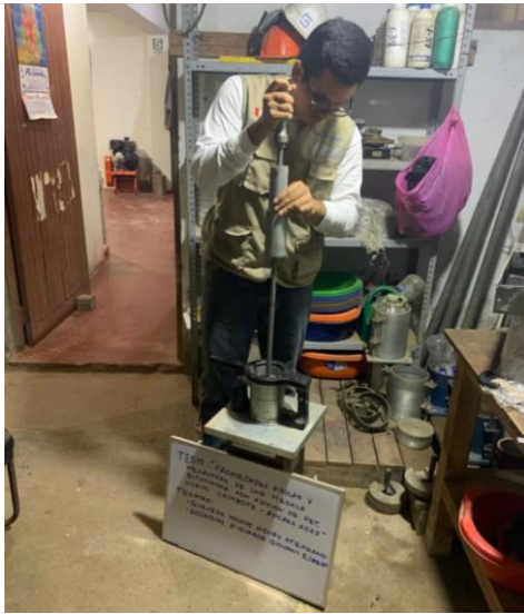
Ilustración 12. Compactación de briquetas asfálticas
