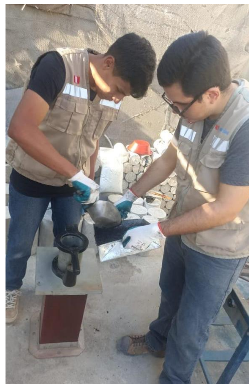
Ilustración 11. Llenado de briquetas asfálticas
