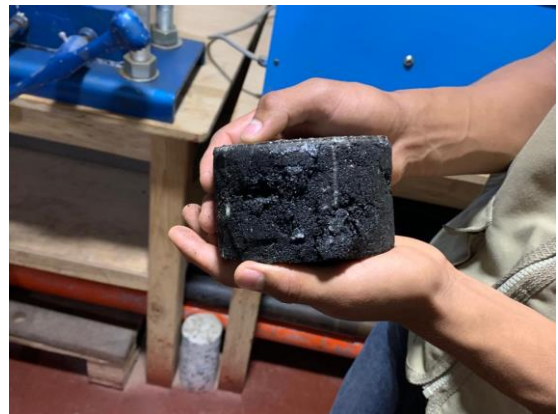
Ilustración 23. Falla en briquetas ensayadas
