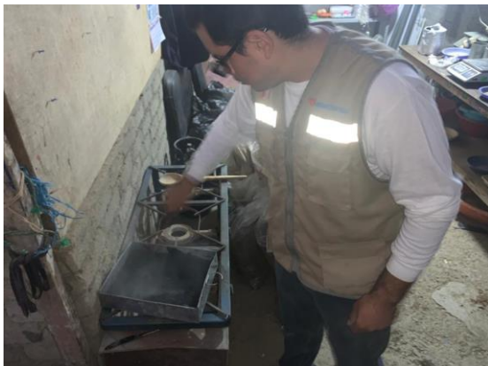
Ilustración 9. Combinación de agregados
