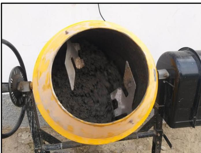
**Imagen 8:** Preparación del concreto para una resistencia  $f'c=210\text{kg/cm}^2$ .
