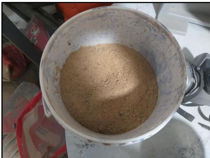
**Imagen 5:** Resultado del vidrio molido, tras la molienda mediante la máquina de los ángeles.
