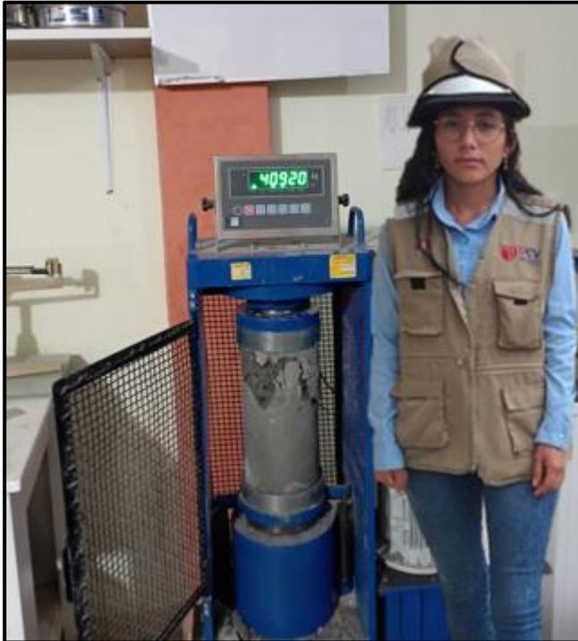
**Imagen 13:** Rotura de probetas con sustitución de 15%VM+5%CCA mediante ensayo de resistencia a la compresión.
