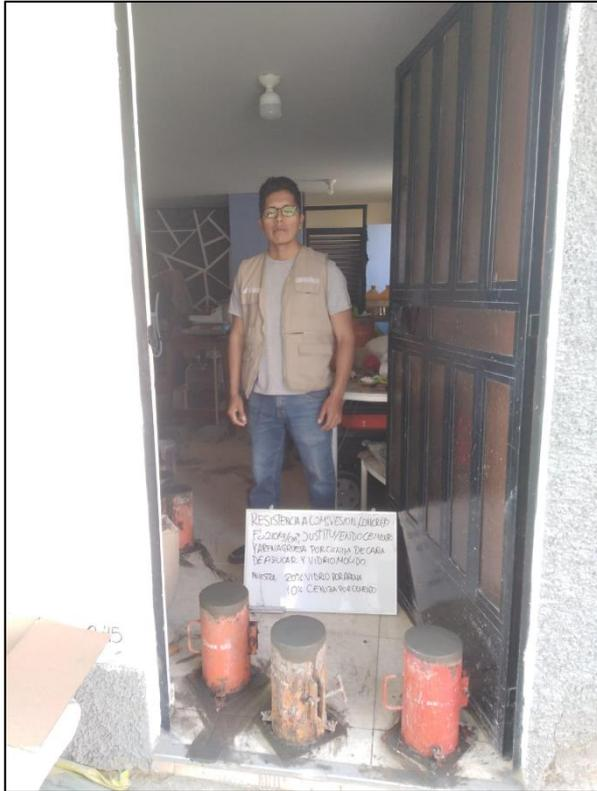
**Imagen 11:** Elaboración de probetas con sustitución de vidrio molido por arena gruesa y cemento por ceniza de caña de azúcar.
