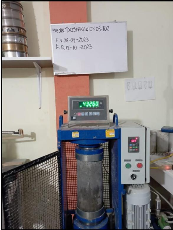
**Imagen 15:** Rotura de probetas con sustitución de 20%VM+5%CCA mediante ensayo de resistencia a la compresión.
