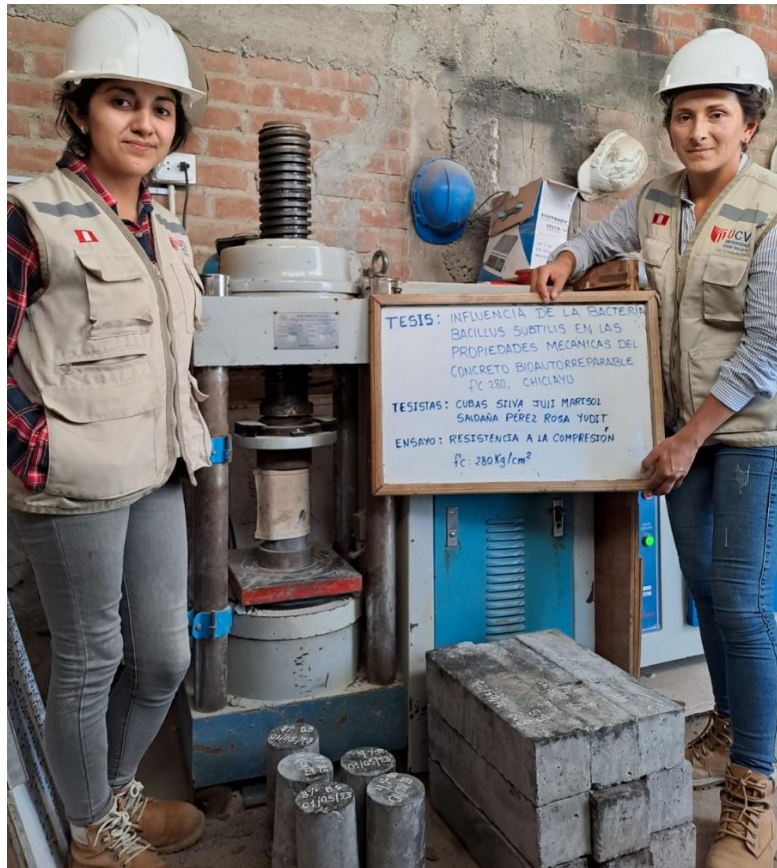
Rotura de probetas (resistencia a la compresión).
