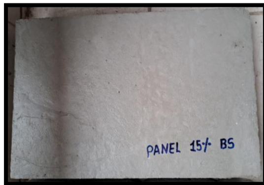
Evaluación de paneles por contracción plástica durante 24 horas.
