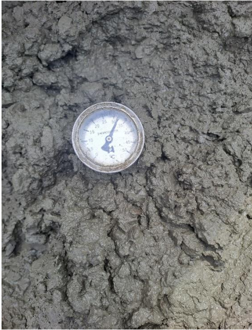
Temperatura del concreto.
