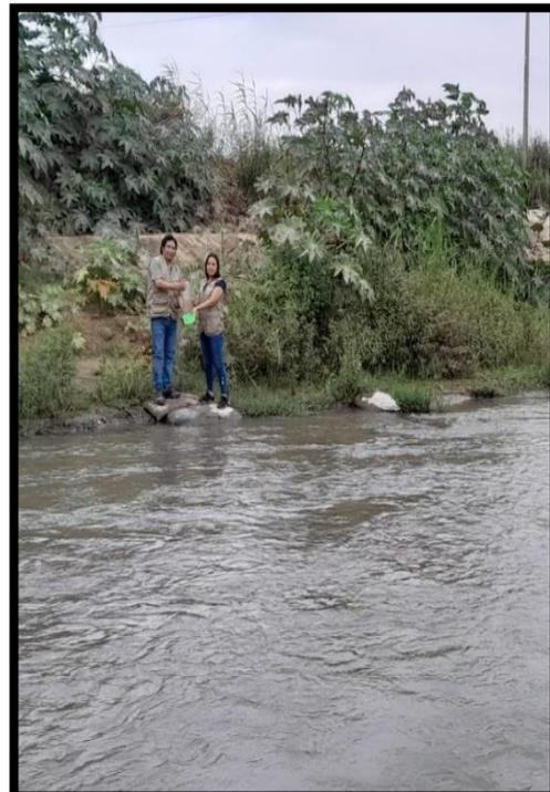
Recolección de agua del Río Lacramarca; extraída 2 puntos en el tramo entre la Av. Perú y Prolongación Jorge Chávez, para la elaboración y curado de las probetas.
