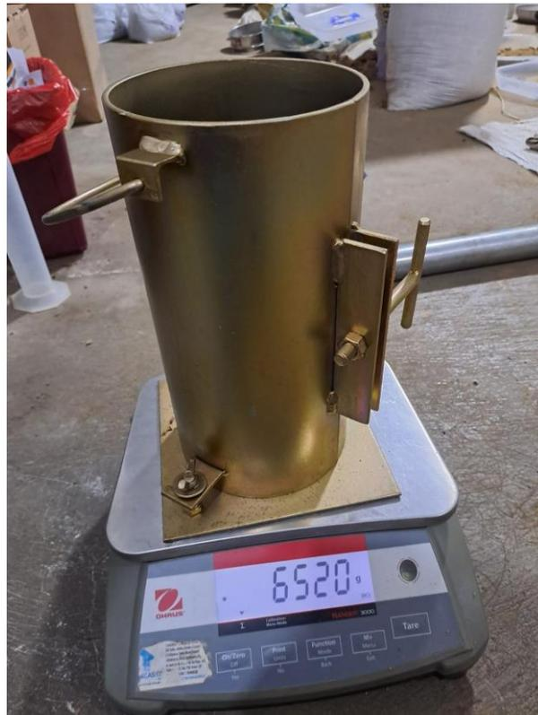
Figura 16. Peso del molde para elaboración de probetas cilíndricas.
