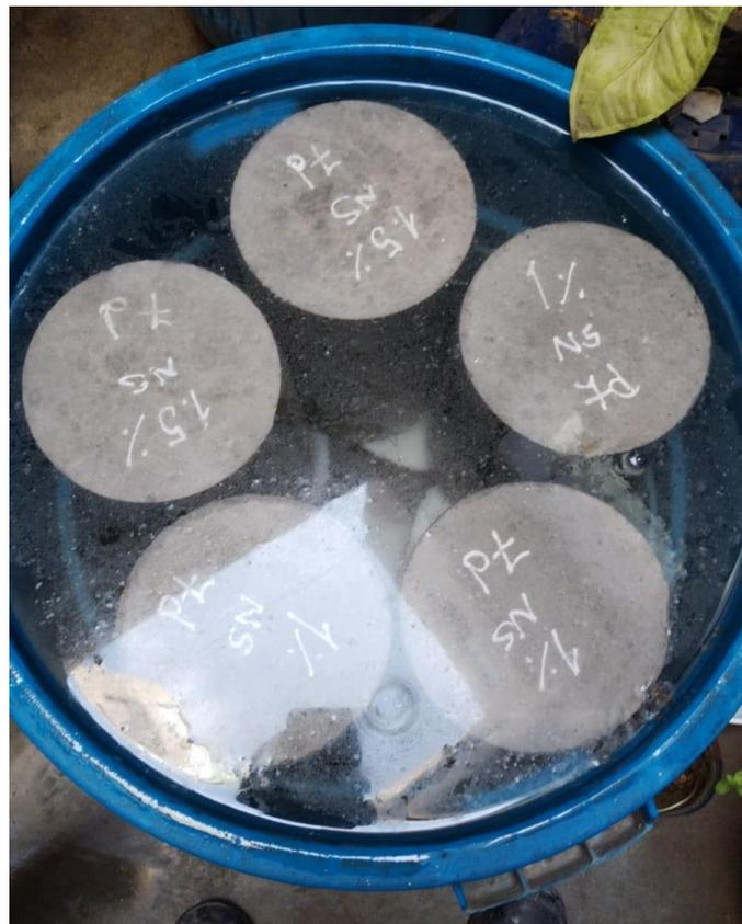
Figura 10. Curado de probetas de concreto con nanosilice para el ensayo a compresión.
