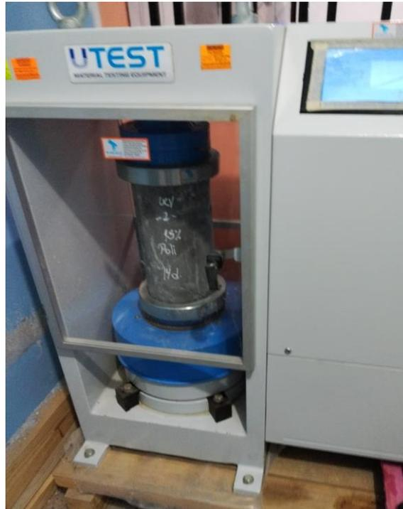
*Figura 13.* Rotura de probeta de concreto con polipropileno en ensayo a compresión.
