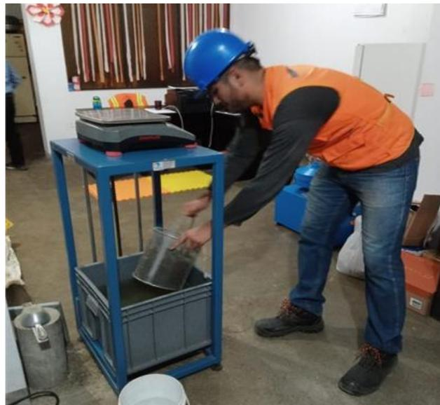
*Figura 4.* Peso del agregado grueso por medio de la balanza hidrostática, material pasado por el tamiz N° 4.
