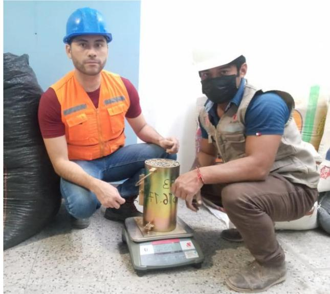
*Figura 3.* Peso del agregado grueso para el análisis del peso unitario sea material suelto o compactado.
