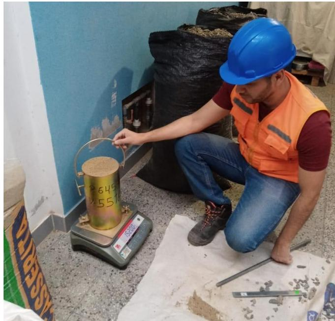
*Figura 2.* Peso del agregado fino para el análisis del peso unitario sea material suelto o compactado.
