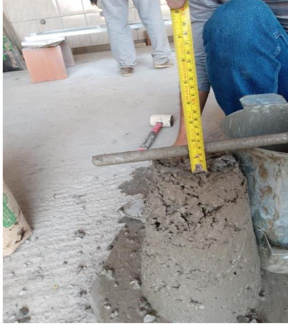
*Figura 7.* Prueba de asentamiento del concreto fresco con polipropileno con el uso del cono de Abrams.
