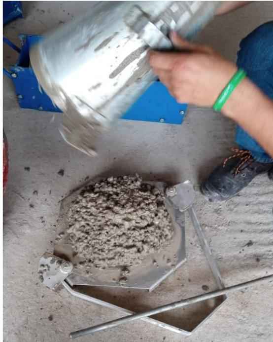
*Figura 8.* Prueba de asentamiento del concreto fresco con nanosílice con el uso del cono de Abrams.
