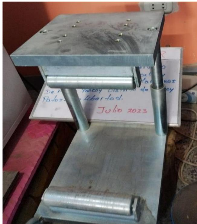
Figura 18. Plataforma para rotura a flexión de testigos de concreto.
