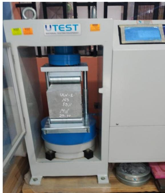
*Figura 12.* Rotura de testigo de concreto con nanosilíce para el ensayo a flexión.
