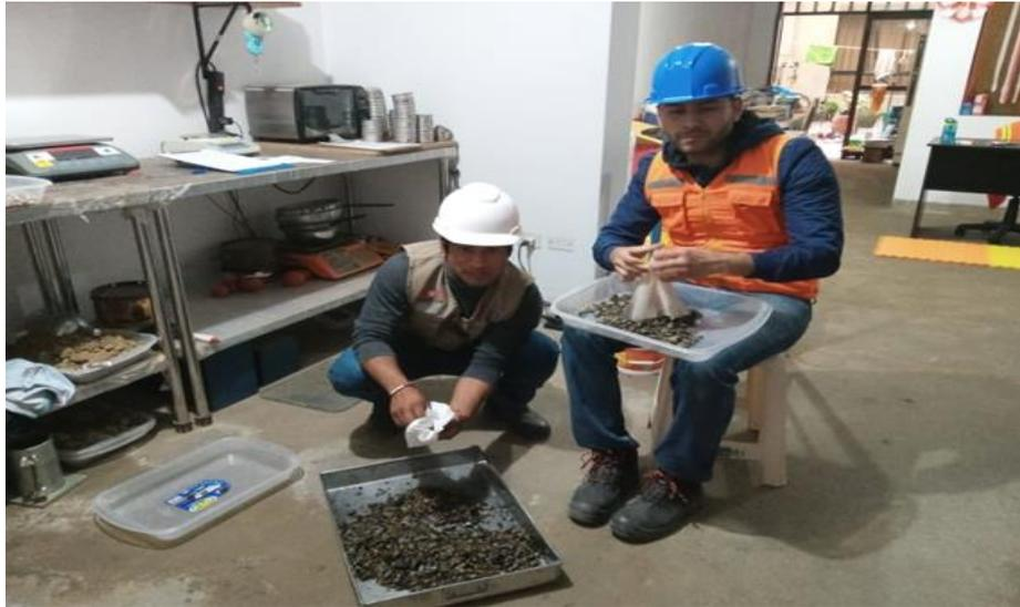
*Figura 5.* Secado del agregado grueso. Material Saturado Superficialmente Seco.
