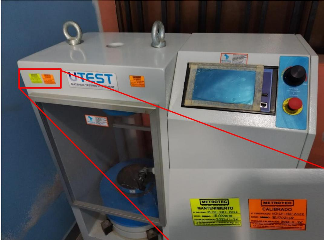
Figura 17. Prensa calibrada para los ensayos de compresión y flexión de probetas y testigos de concreto.
