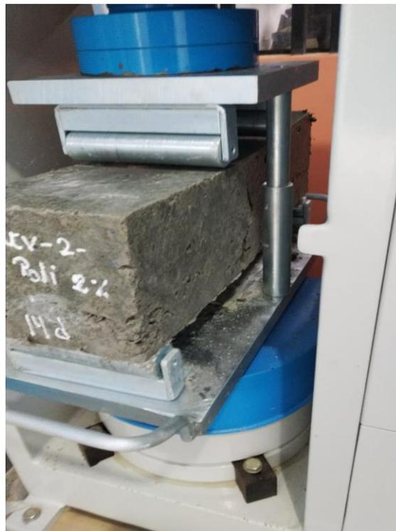
*Figura 14.* Rotura de testigo de concreto con polipropileno para el ensayo a flexión.
