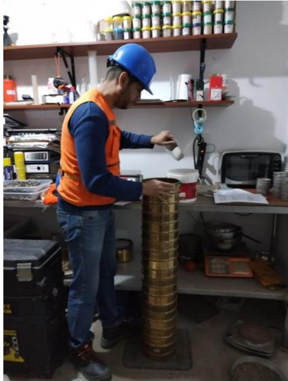
*Figura 1.* Proceso de tamizado para tener los datos granulométricos de los agregados.
