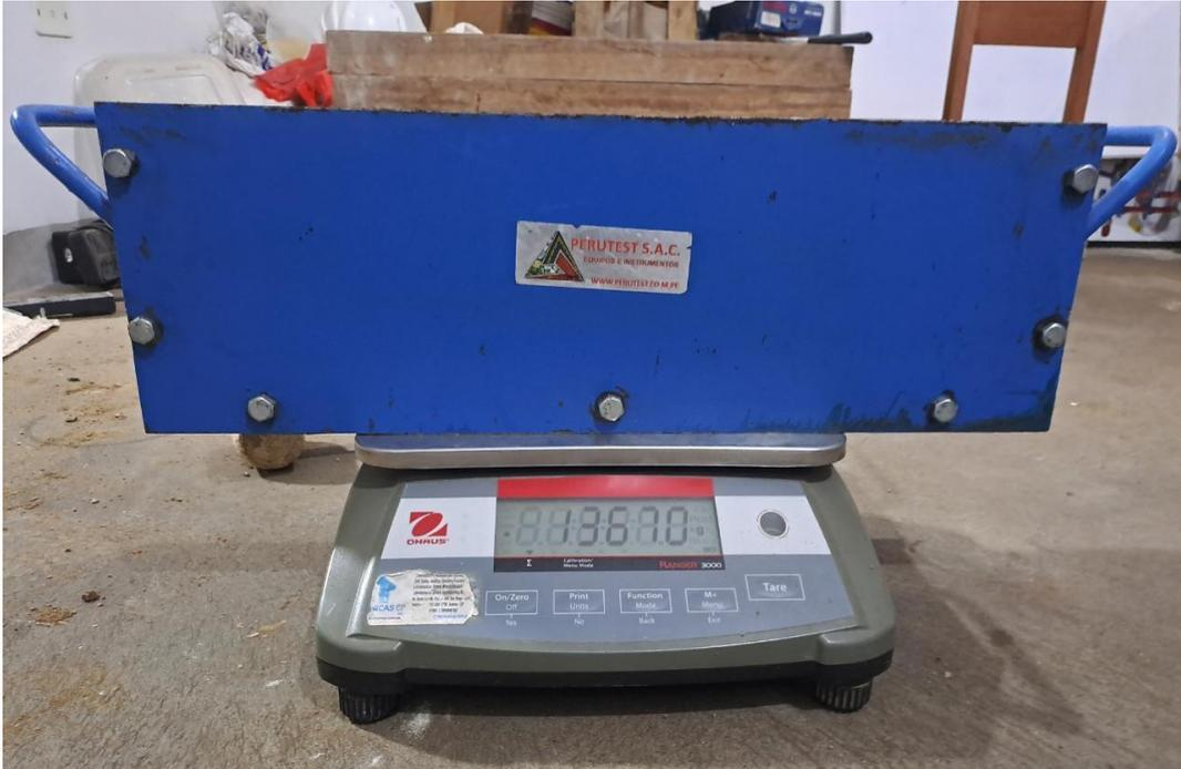
Figura 15. Peso de molde para la elaboración de testigos en forma de paralelepípedo.
