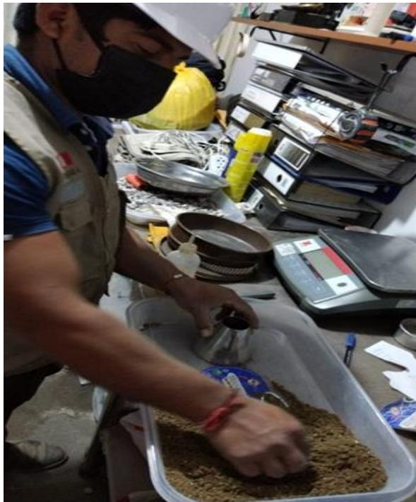
*Figura 6.* Ensayo del cono para determinar el estado saturado superficialmente seco del agregado fino.
