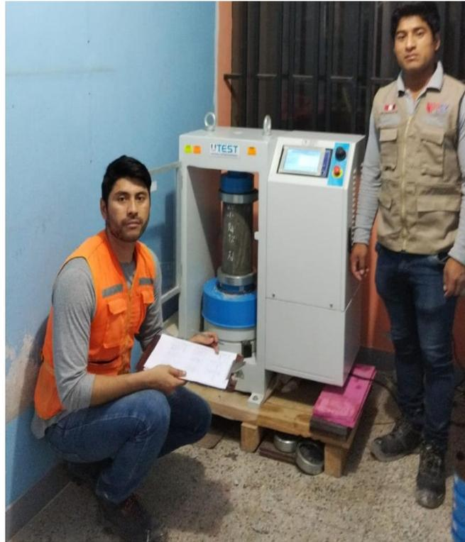
*Figura 11.* Rotura de probeta de concreto con nanosilíce en ensayo a compresión.
