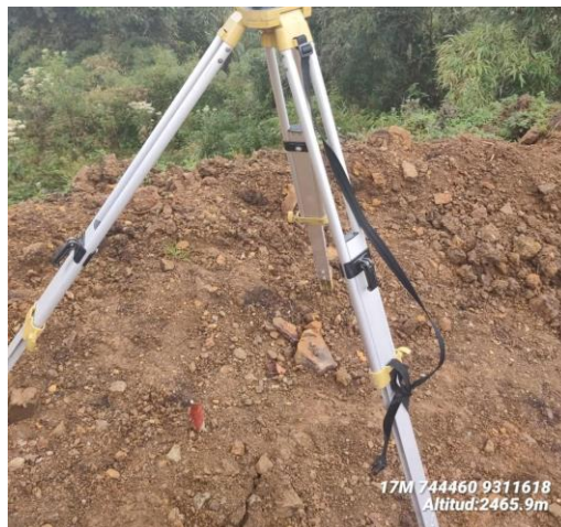
Figura 2. Trípode de Aluminio TOPCON TP 110. Altura útil mínima 100cm.
