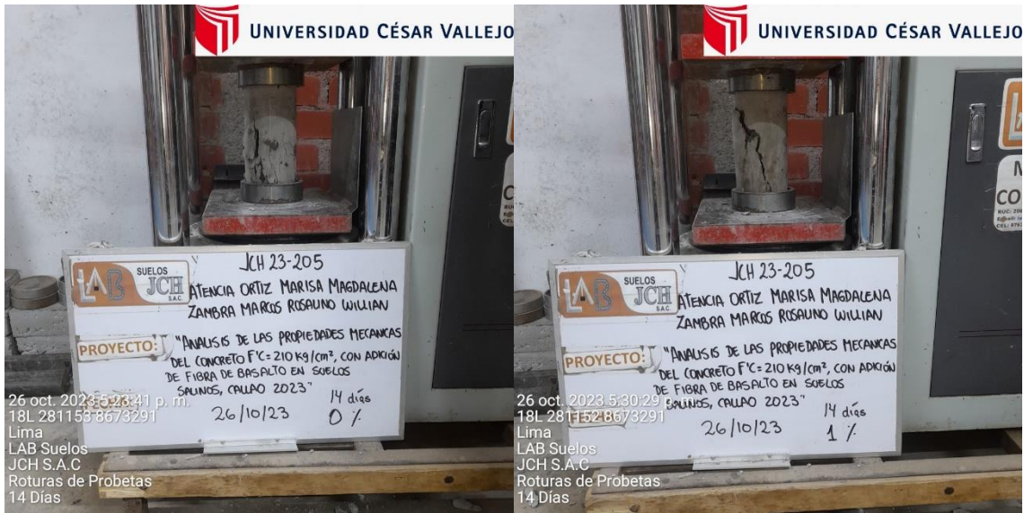
Ensayo de compresión de muestras cilíndricas con 0% y 1.0% de adición de Fibra de Basalto a los 14 días.
