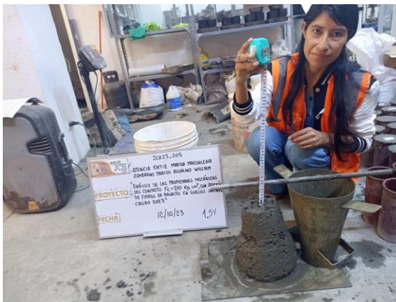
Prueba de Asentamiento del concreto
