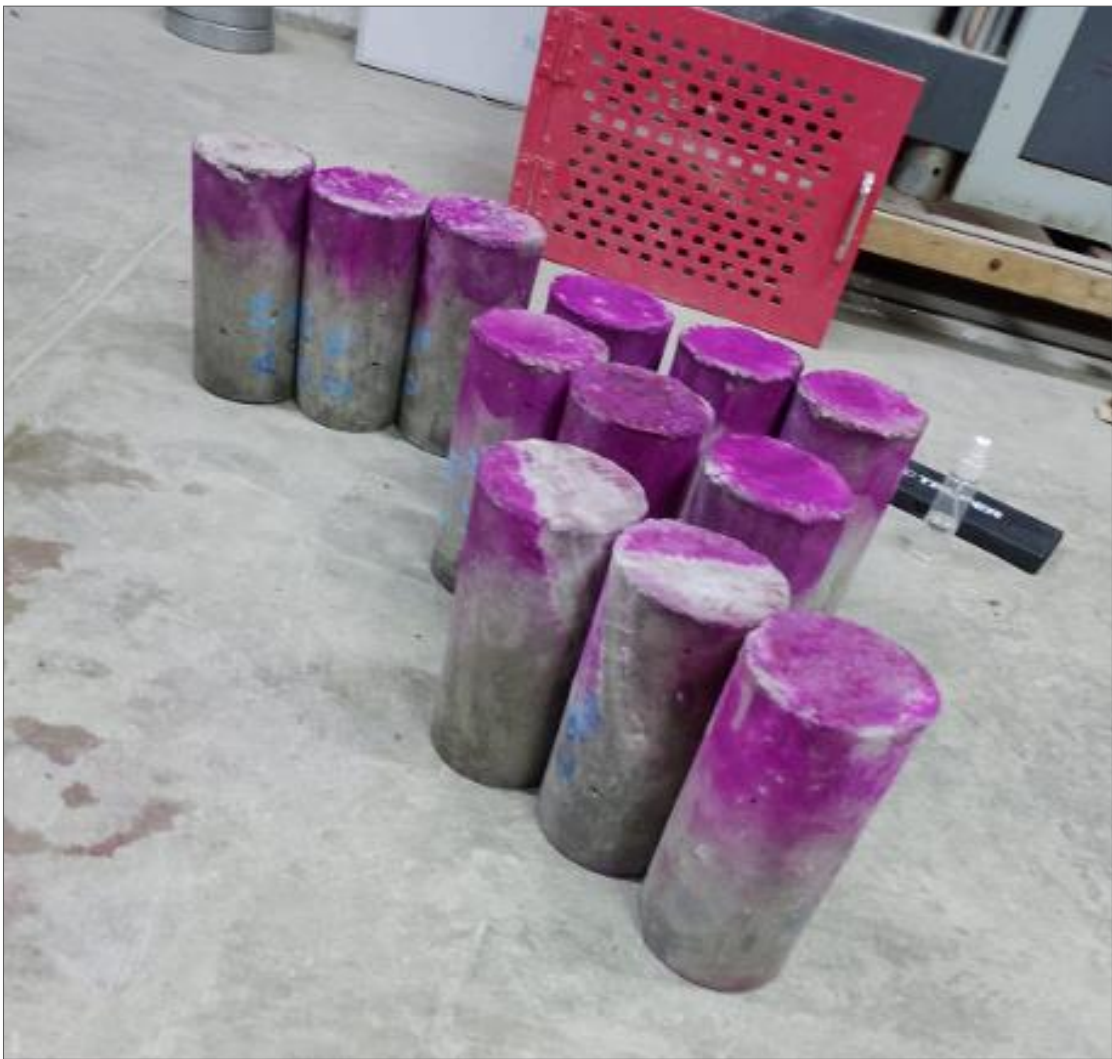
Figura 9. Muestras ensayadas con fenolftaleína
