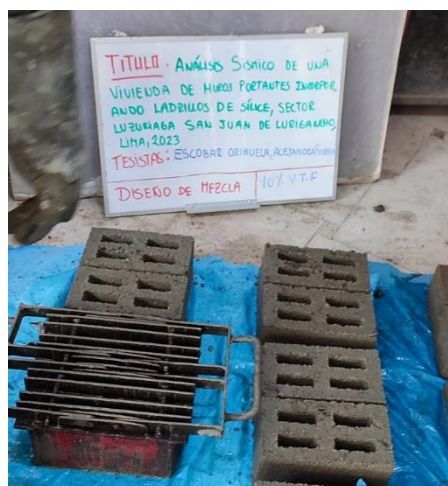
Figura N°1: Molde para la fabricación de ladrillos
