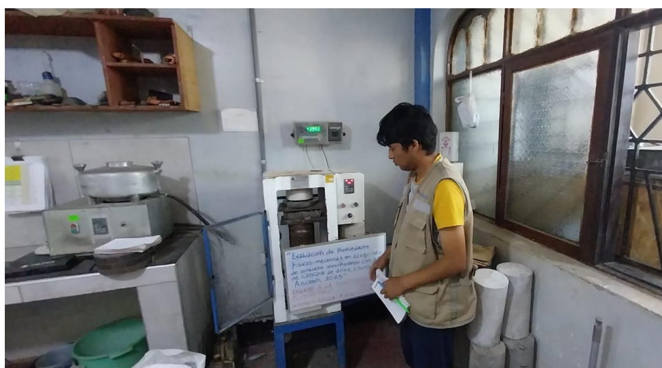
Figura 15. Ensayo a la compresión.
