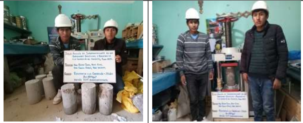
Ensayo de resistencia a la compresión del concreto
