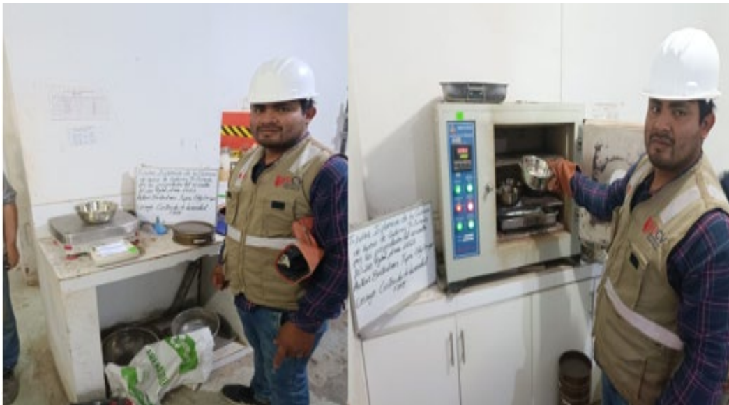
Figura 18: Ensayo Contenido de Humedad (fino)
