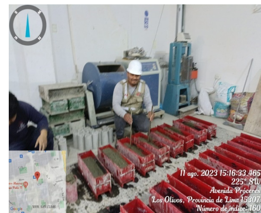
Llenado de las vigas prismáticas
